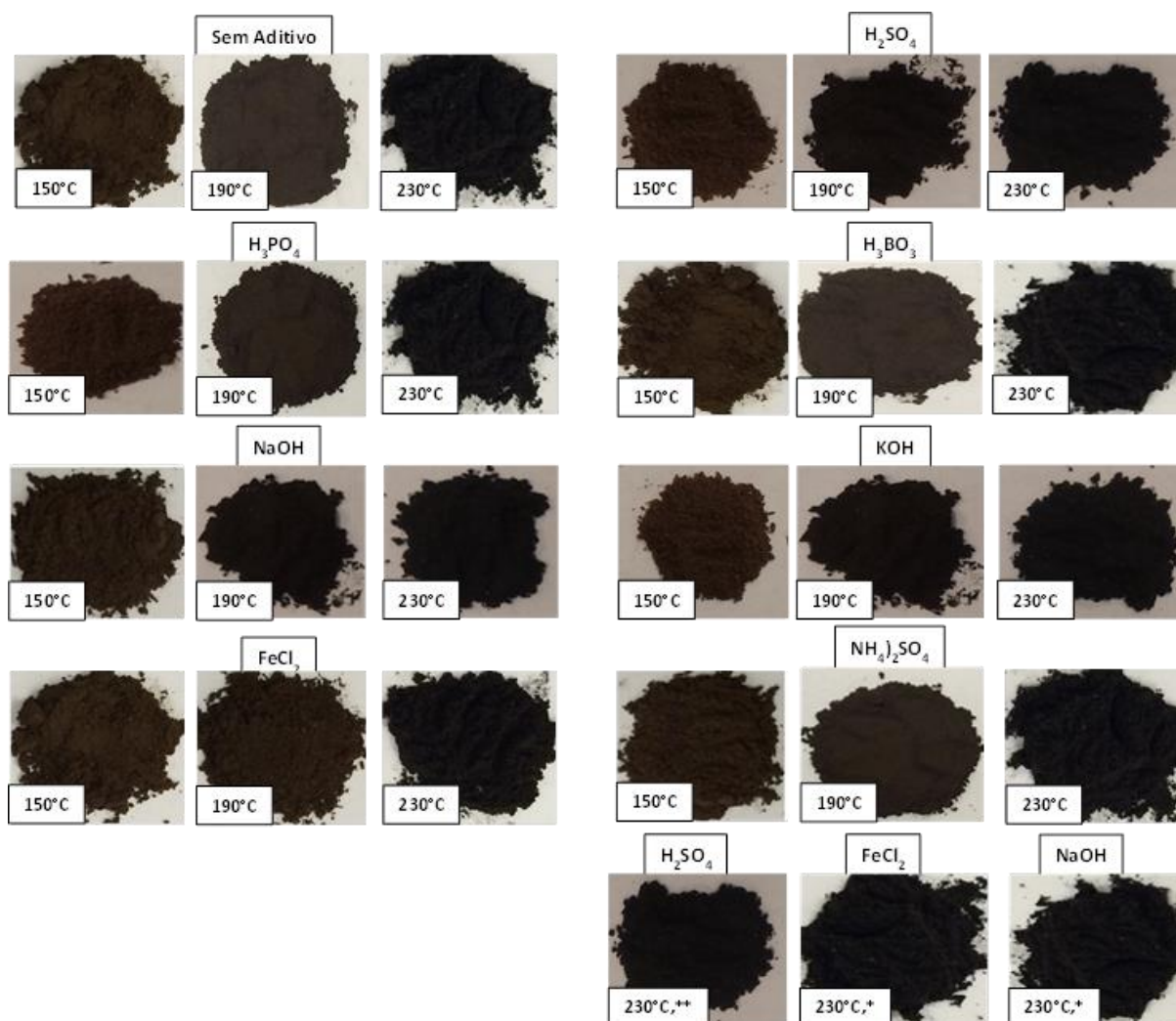
Figura 2. Imagens dos hidrochars obtidos da carbonização hidrotérmica da mistura de bagaço de cana-de-açúcar e vinhaça na presença e ausência de aditivos ácidos, básicos e salinos, nas temperaturas de 150, 190 e 230 °C. Para a reação (***) a concentração do aditivo foi de 0,5 mol L -1 , e para as reações (*) a concentração do aditivo foi de 0,4 mol L -1 .
