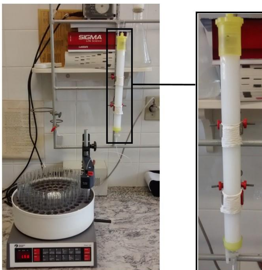
Figura 9: Coluna de gel Sephadex G-15 usada na Cromatografia de filtração em gel para "desalting".
