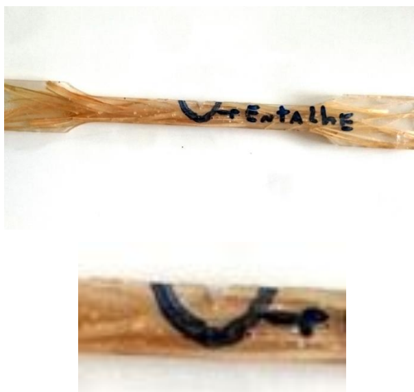
Figura 22 - Formato dos corpos de prova utilizados para o ensaio de K_{1c} .
