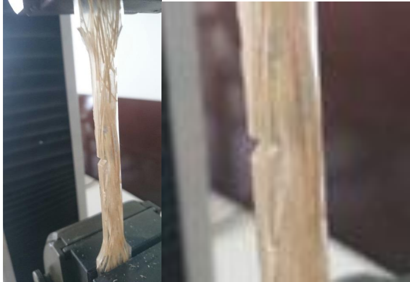
Figura 23 - Ensaio de tração para determinação do K_{1c} .
