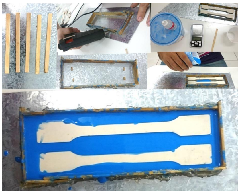
Figura 16 – Processo de montagem do molde em silicone.
