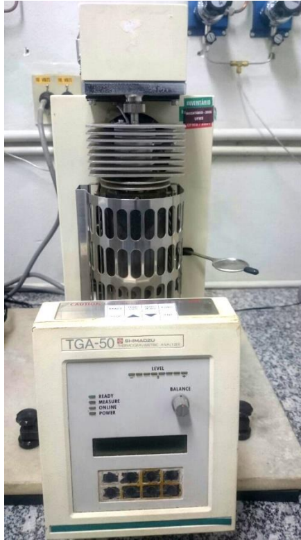
Figura 24 - Equipamento da marca SHIMADZU modelo TGA-50.
