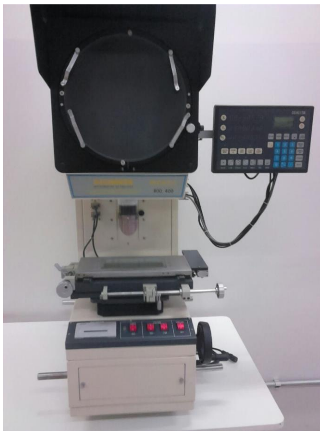
Figura 18 – Projetor DIGIMESS MODEL 400, utilizado para medir os diâmetros das fibras de Buriti.
