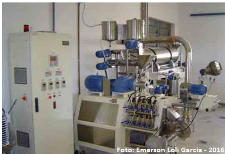
Figura 11 - Sistema completo de extrusão INBRA-RX
