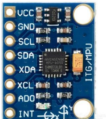
Figura 14 – Acelerômetro e Giroscópio MPU-6050.
