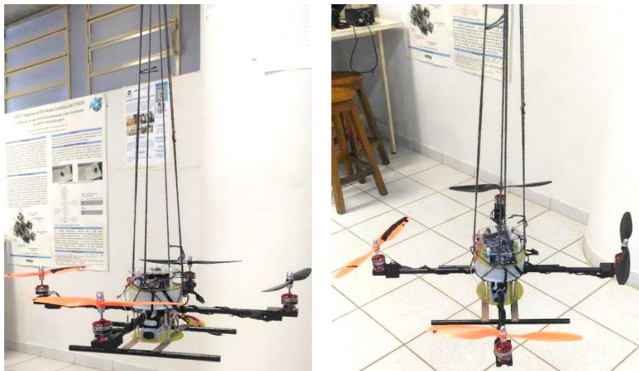
Figura 47 – Ensaio de voo com o quadricóptero amparado por cordas de sustentação.
