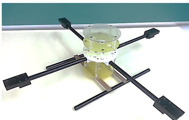
Figura 8 – Estrutura ( frame ) construída.
