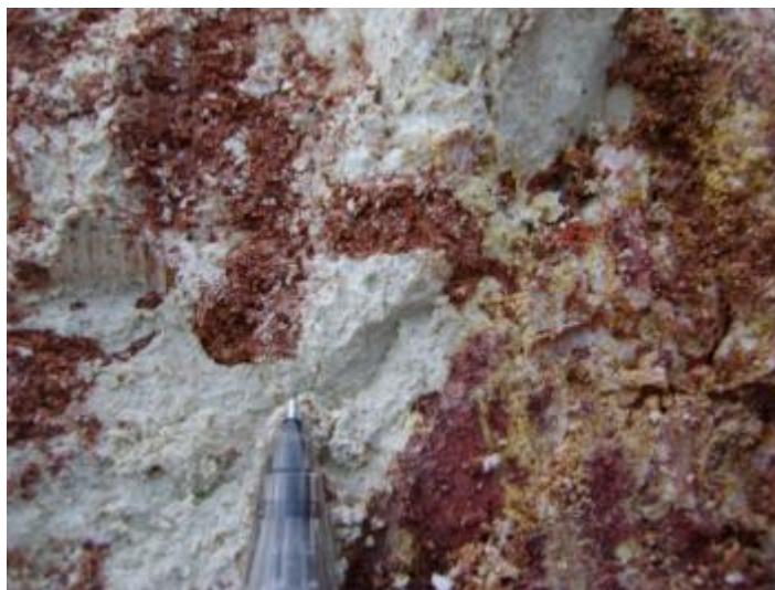
Figura 12 - Zonas completamente brancas associadas com outras compostas por numerosas pontuações que integram as três matrizes vermelha, branca e amarela.
