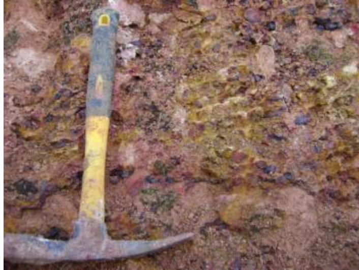
Figura 7 - Lentes de argila branca orientadas horizontalmente entre as camadas de deposição sedimentar que, em conjunto com o material argiloso amarelo, formam um retículo que isola concreções ferruginosas muito duras, vermelhas muito escuras.
