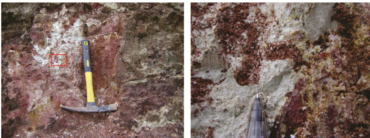
Figura 13 - Foto geral e foto de detalhe mostrando a interligação entre as matrizes vermelha, branca e amarela, apresentando as diferentes maneiras como apresenta-se no perfil.
