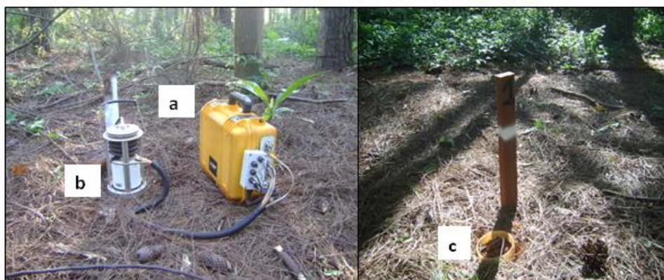
Figura 3- Sistema LI-8100 interligado à câmara de solos (a), e câmara para solo inserida sobre o colar de PVC (b), colar de PVC inseridos no solo na área de pinus (c)
