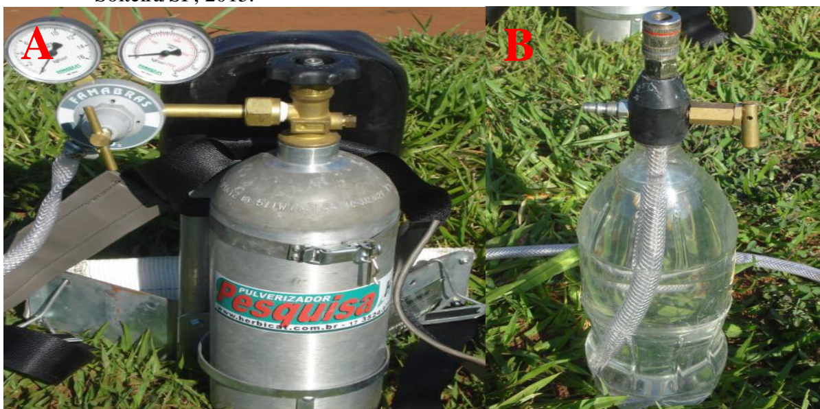
Figura 2 - Pulverizador costal utilizado para a aplicação das doses do herbicida e do N foliar. Bomba costal pressurizada a CO 2 (A) e garrafas descartáveis de dois litros (B). Ilha Solteira/SP, 2015.
