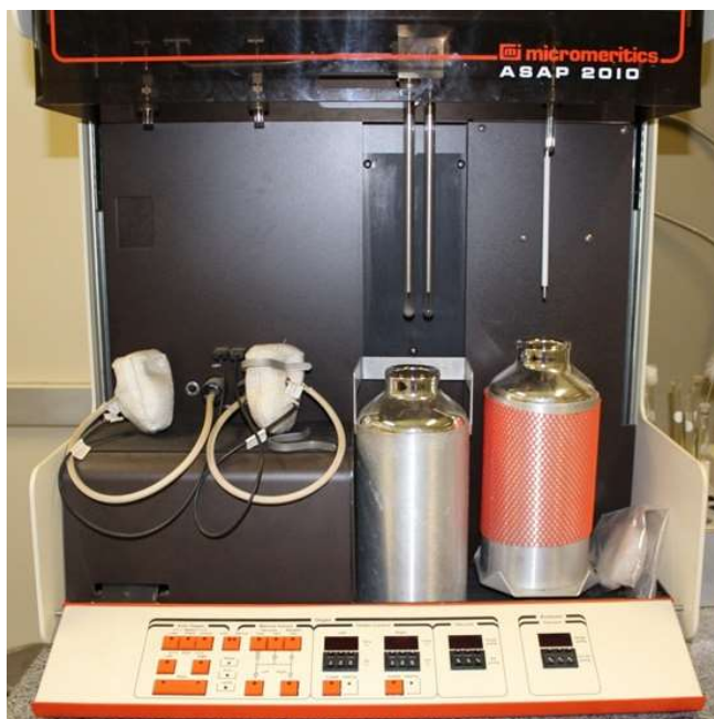
Figura 3.7: Imagem do equipamento utilizado para fazer análises de adsorção de Nitrogênio a 77K.
