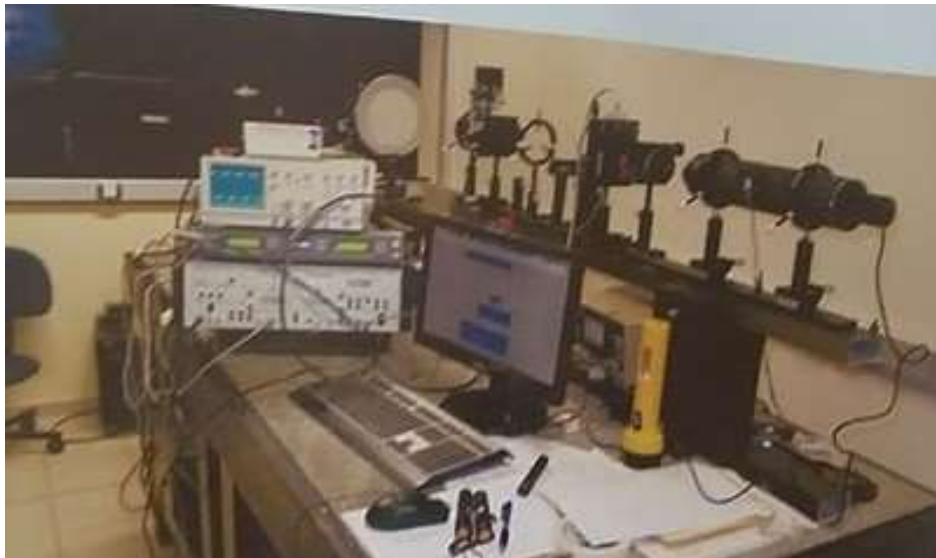
Figura 3.16: Imagem do aparato experimental utilizado para as medida de espalhamento de luz visível com comprimentos de onda de 405 nm, 543 nm e 612 nm.
