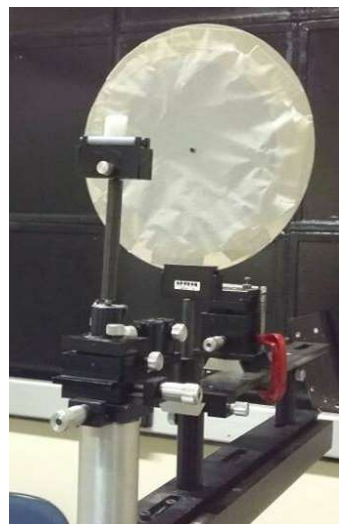
Figura 3.17: Imagem do porta amostra utilizado para as medida de espalhamento de luz visível com comprimentos de onda de 405 nm, 543 nm e 612 nm.
