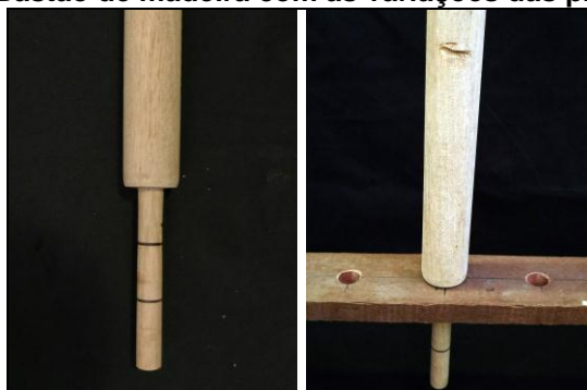
Figura 10 - Bastão de madeira com as variações das profundidades
