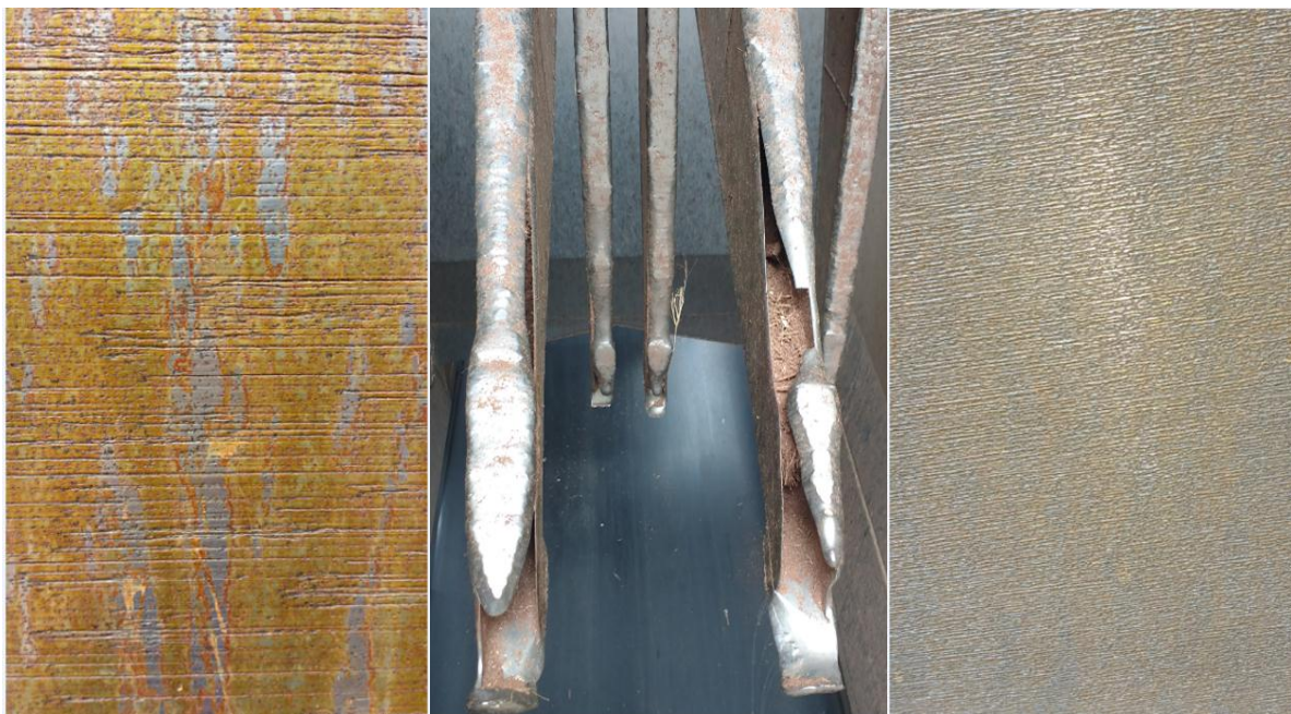
Figura 7 - Exemplos de desgaste da unidade de estudo Fonte: Próprio autor
