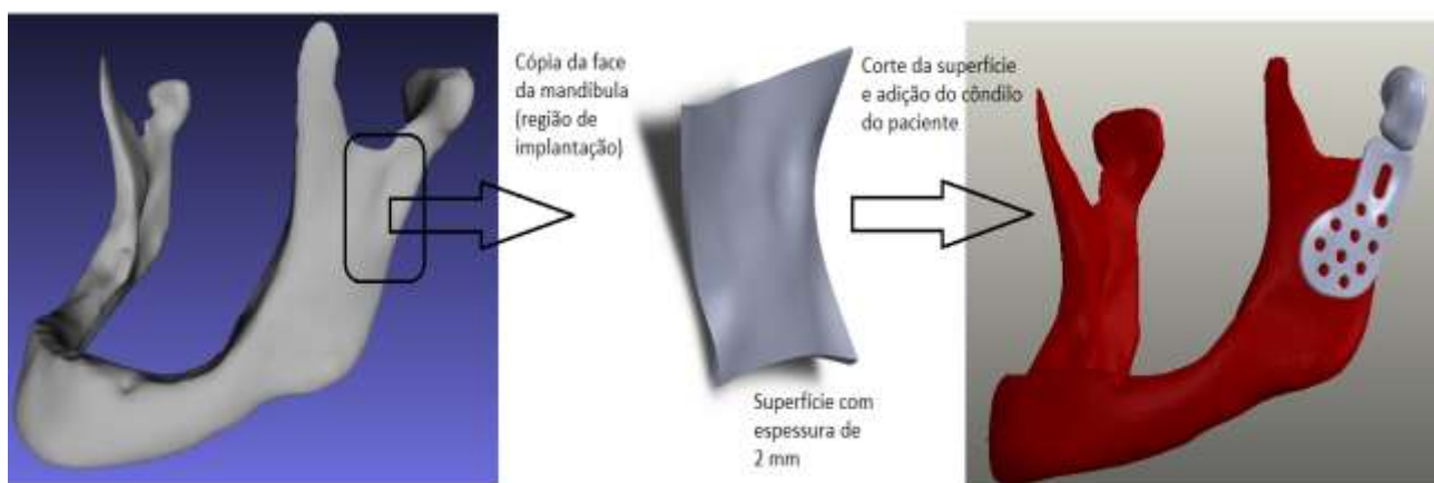
Figura 46 – Superfície espelhada da mandíbula mostrando a espessura do implante
