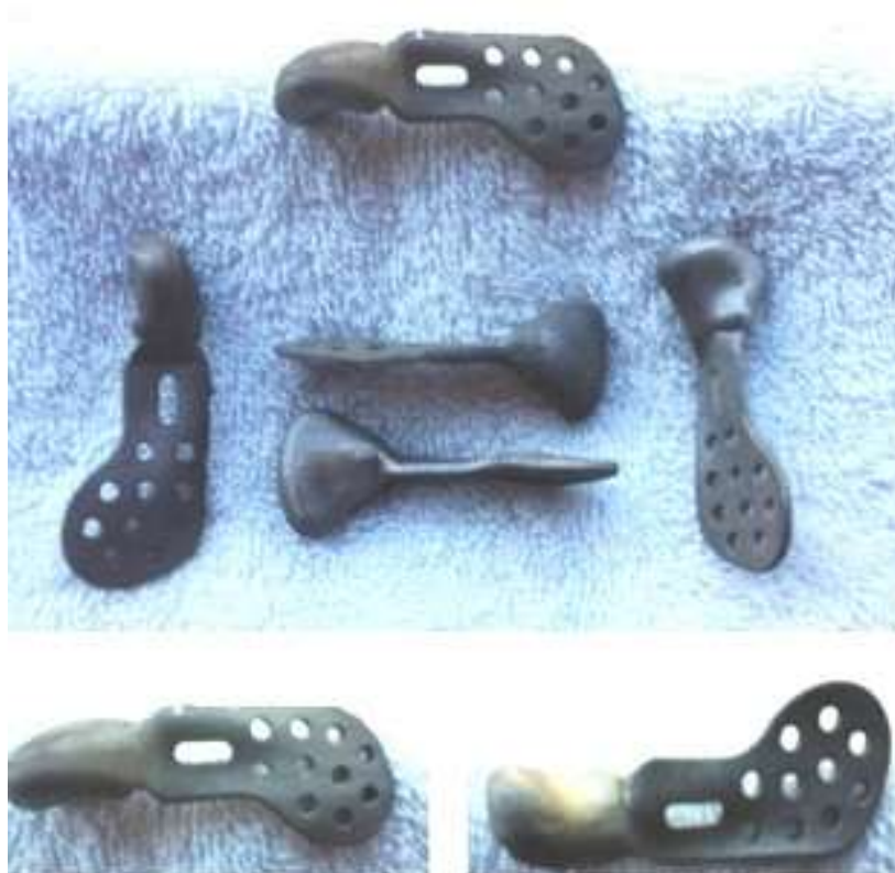
Figura 55 – Próteses em titânio fabricadas por manufatura aditiva DMLS no equipamento EOSINT M270
