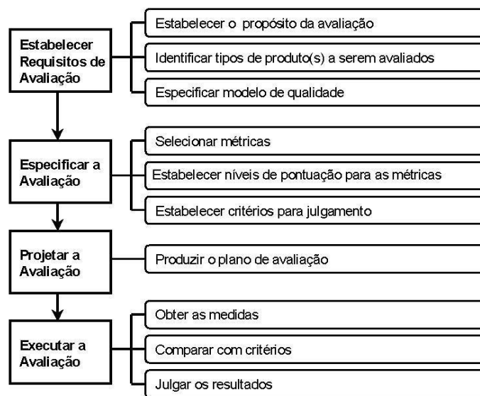
Imagem 13 - Visão geral do processo de avaliação segundo a norma NBR ISO/IEC 14598-1.
