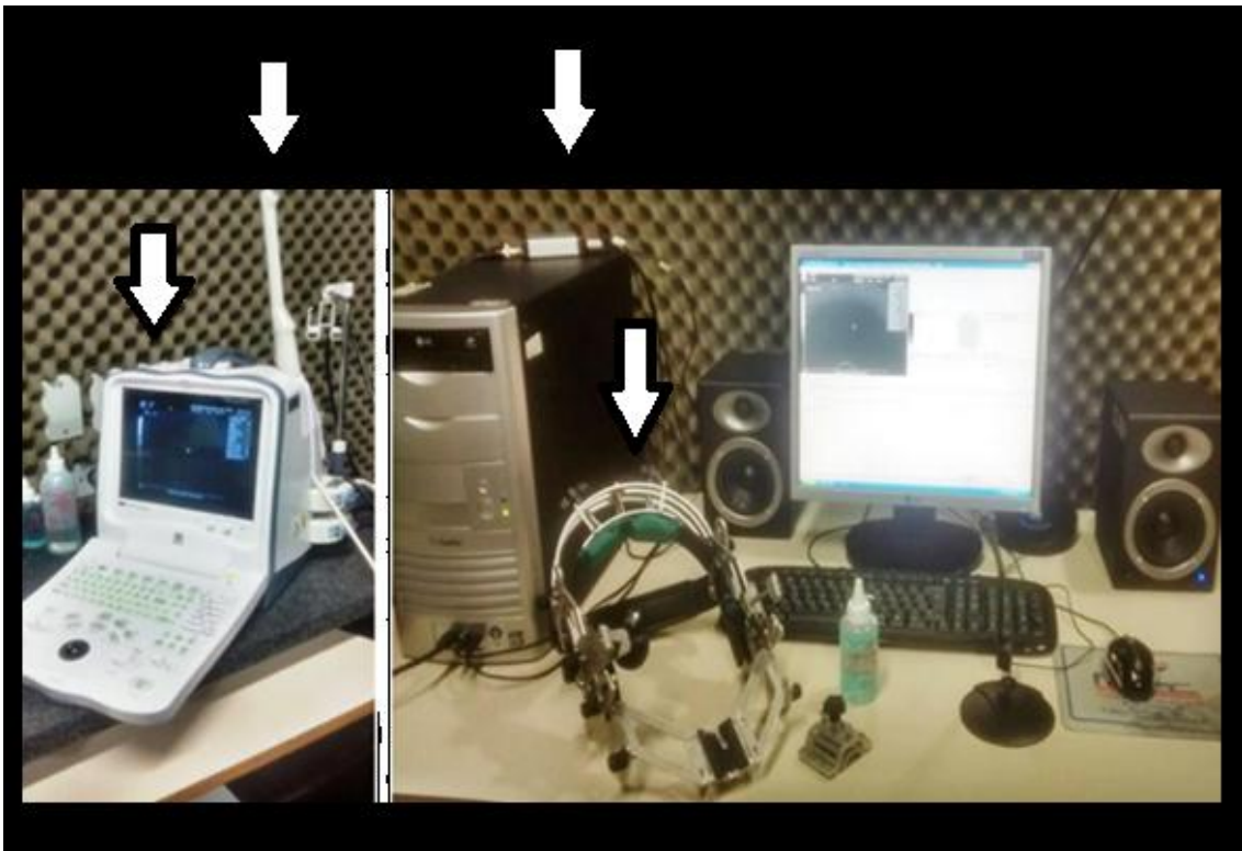
Figura 2: As setas da esquerda para a direita representam respectivamente: ultrassom portátil, transdutor acoplado ao computador, sincronizador e estabilizador de cabeça.
