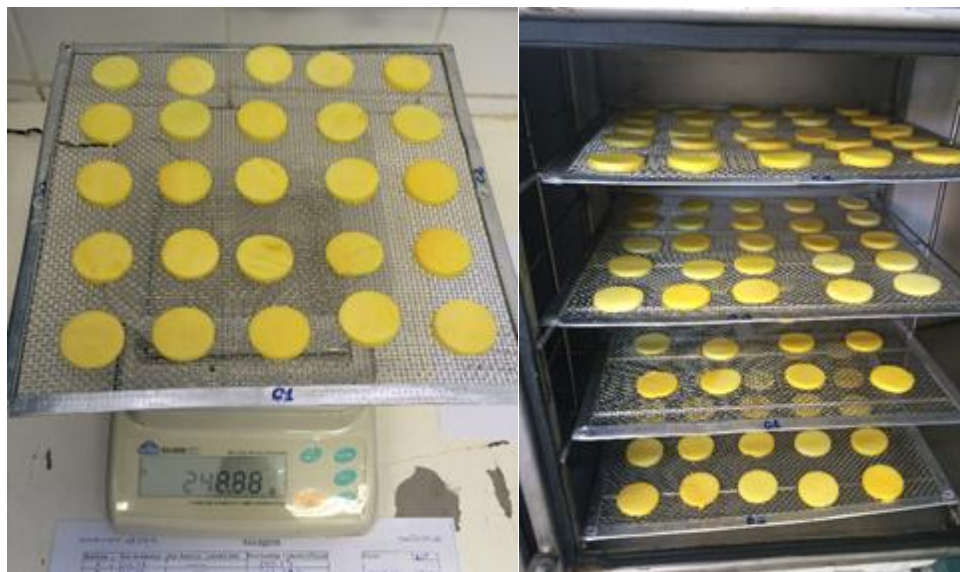
Figura 5: Disposição das amostras em bandejas de alumínio (à esquerda no momento da pesagem e à direita dentro do secador).
