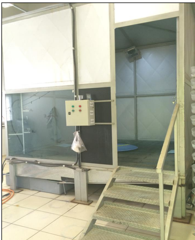
Figura 8. Câmara de teste de avaliação da eficiência dos conjuntos de proteção adaptada para avaliação quantitativa de exposição dérmica.
