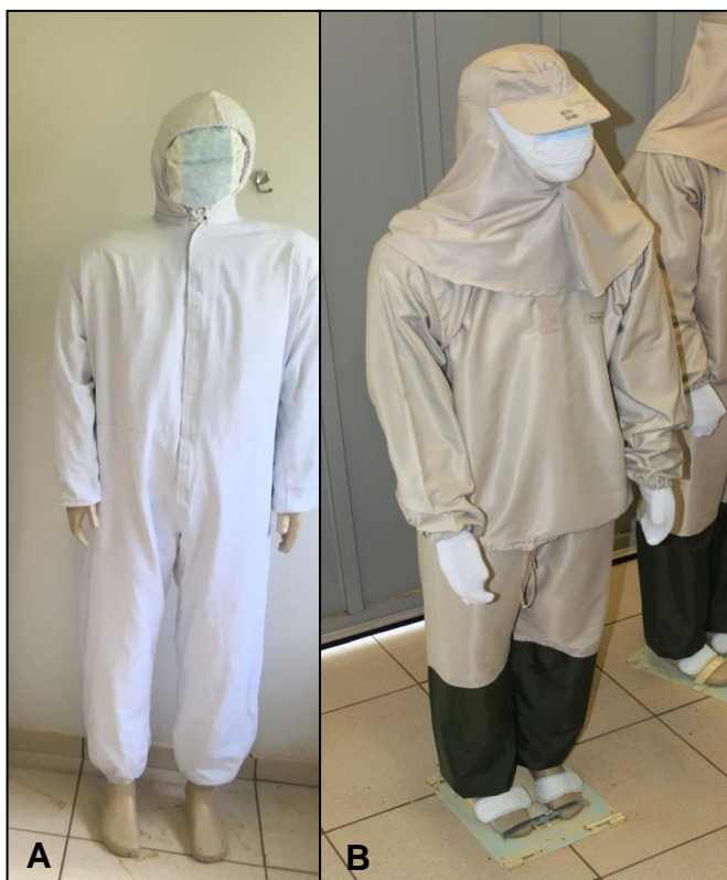
Figura 9. Manequins com as vestimentas de amostragem (A) e com conjunto Costal Sarja Ultra (B) sobre as vestimentas de amostragem para a avaliação da eficácia do conjunto de EPI hidro-repelente.
