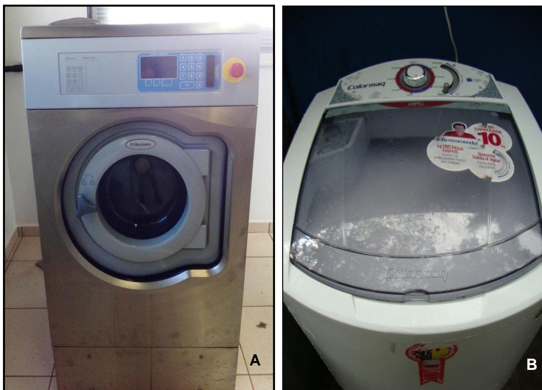
Figura 4. Máquina de lavar roupa padronizada na norma ISO 6330 (ISO, 2000), da marca Electrolux, modelo FOM 71 CLS (A); Lavadora automática, da marca Colormaq, modelo Turbo-10 kg, utilizada para lavagem das vestimentas na Prefeitura de Araraquara (B).
