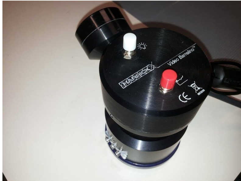
Figura 4 - Sistema de vídeo ATR, Barrelinho® utilizado para medir refletância em sólidos. Fonte: autor do trabalho.
