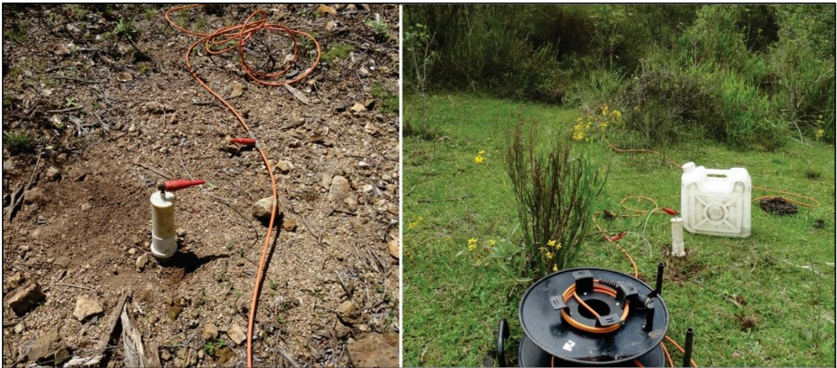
Figura 20- Eletrodos posicionados ao longo do perfil.
