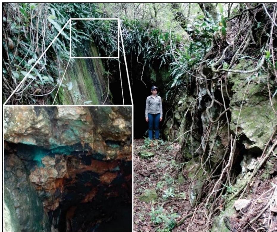
Figura 6 - Galeria de pesquisa contendo alteração do minério de cobre em forma de malaquita (carbonato de cobre).
