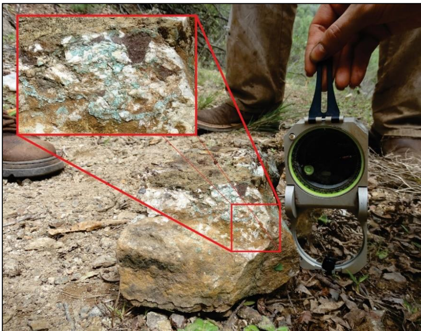
Figura 5 - Carbonato de cobre em amostra localizada na linha 2.
