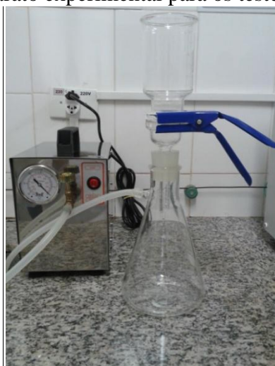
Figura 22: Aparato experimental para os testes de membrana.
