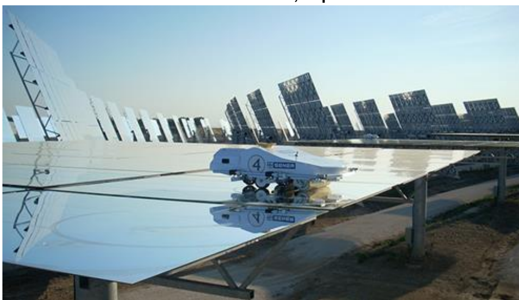
Figura 25 - HECTOR realizando a limpeza da superfície espelhada de um heliostato na PSA, Espanha
