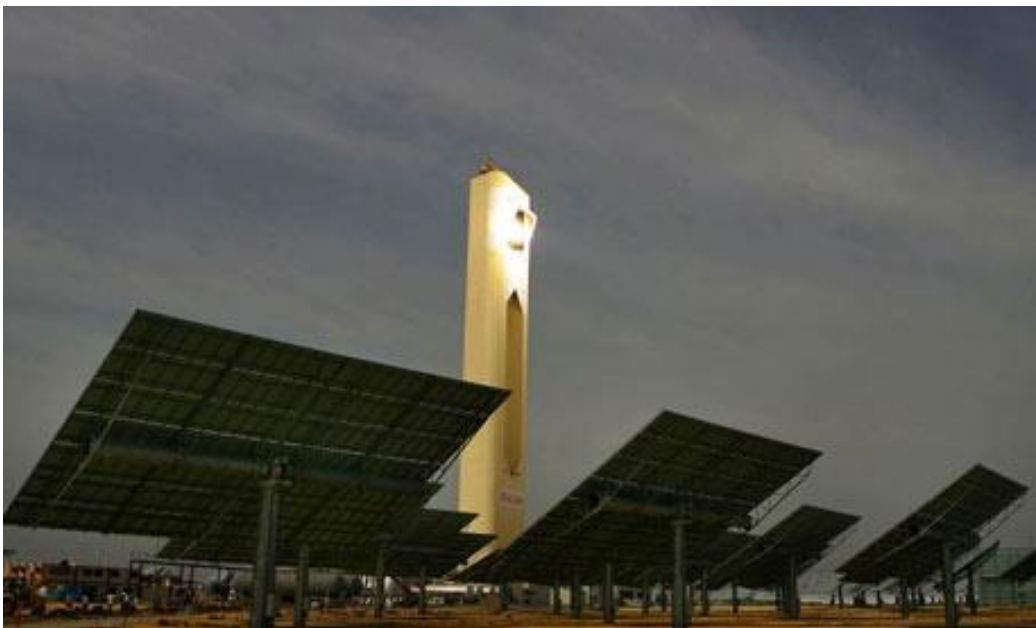
Figura 18 - Heliostato do tipo "T", com eixo de orientação azimute-elevação
