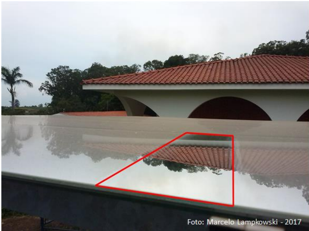
Figura 56 - Sujidade no sexto espelho componente do heliostato (novembro/2016)
