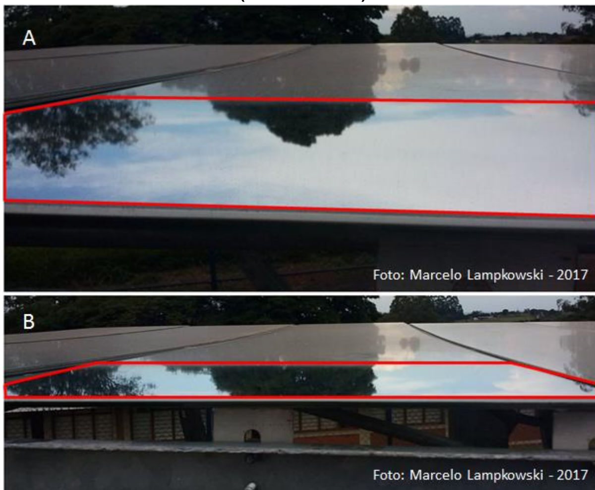
Figura 55 - Sujidade no quarto espelho componente do heliostato (novembro/2016)
