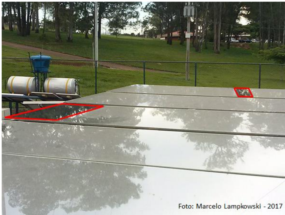
Figura 57 - Sujidade das áreas limpas em relação aos demais espelhos do heliostato (novembro/2016)
