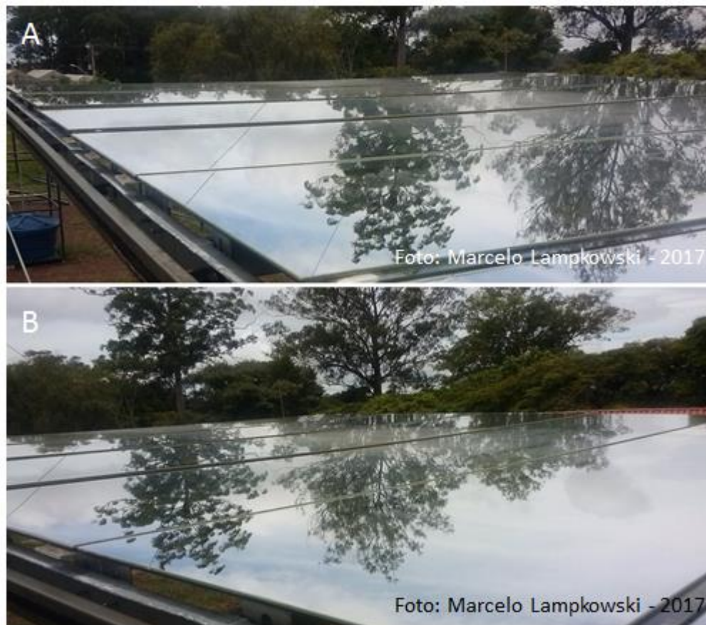
Figura 59 - Situação dos espelhos após ciclos de limpeza realizados em 25/01/2017
