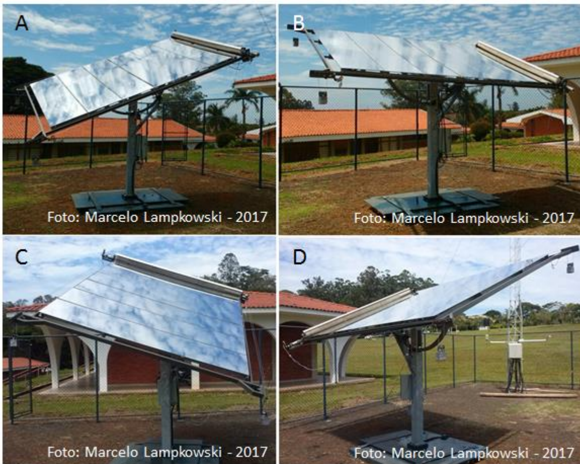
Figura 68 - Mecanismo de limpeza e movimentação do heliostato em diferentes inclinações nos eixos X e Y
