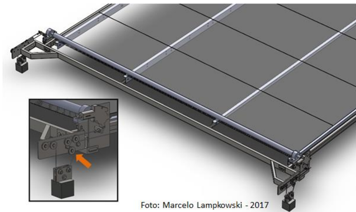
Figura 37 - Parte inferior do mecanismo e roldanas de apoio
