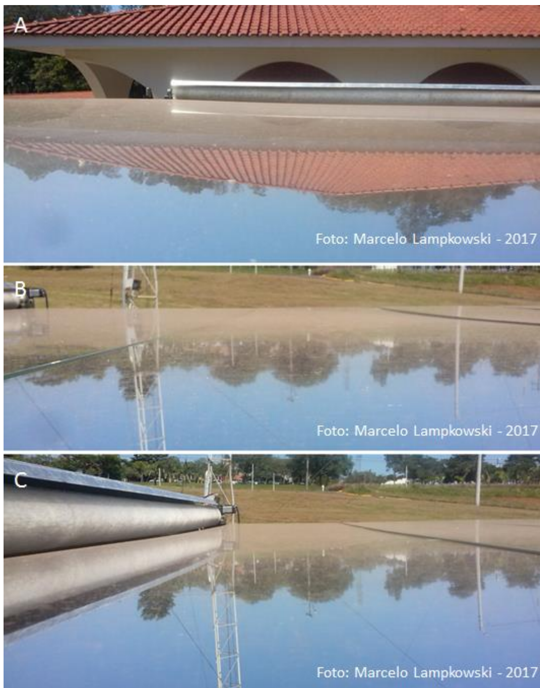
Figura 62 - Situação da sujidade nos espelhos registrada em 16/02/2017
