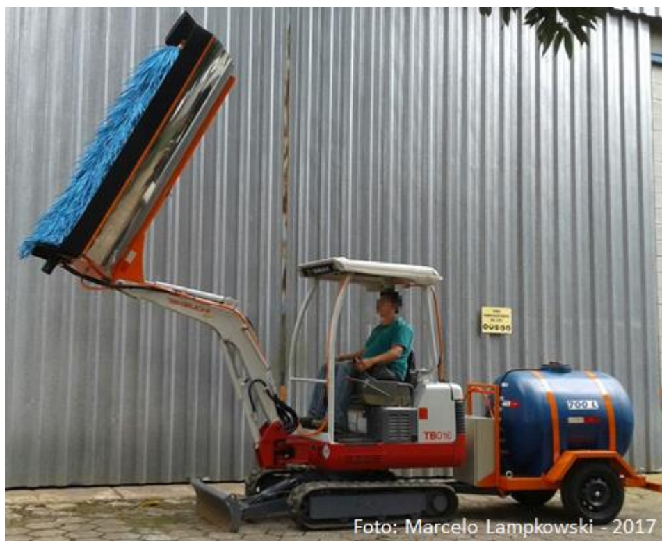
Figura 69 - Escavadeira adaptada para limpeza de painéis fotovoltaicos
