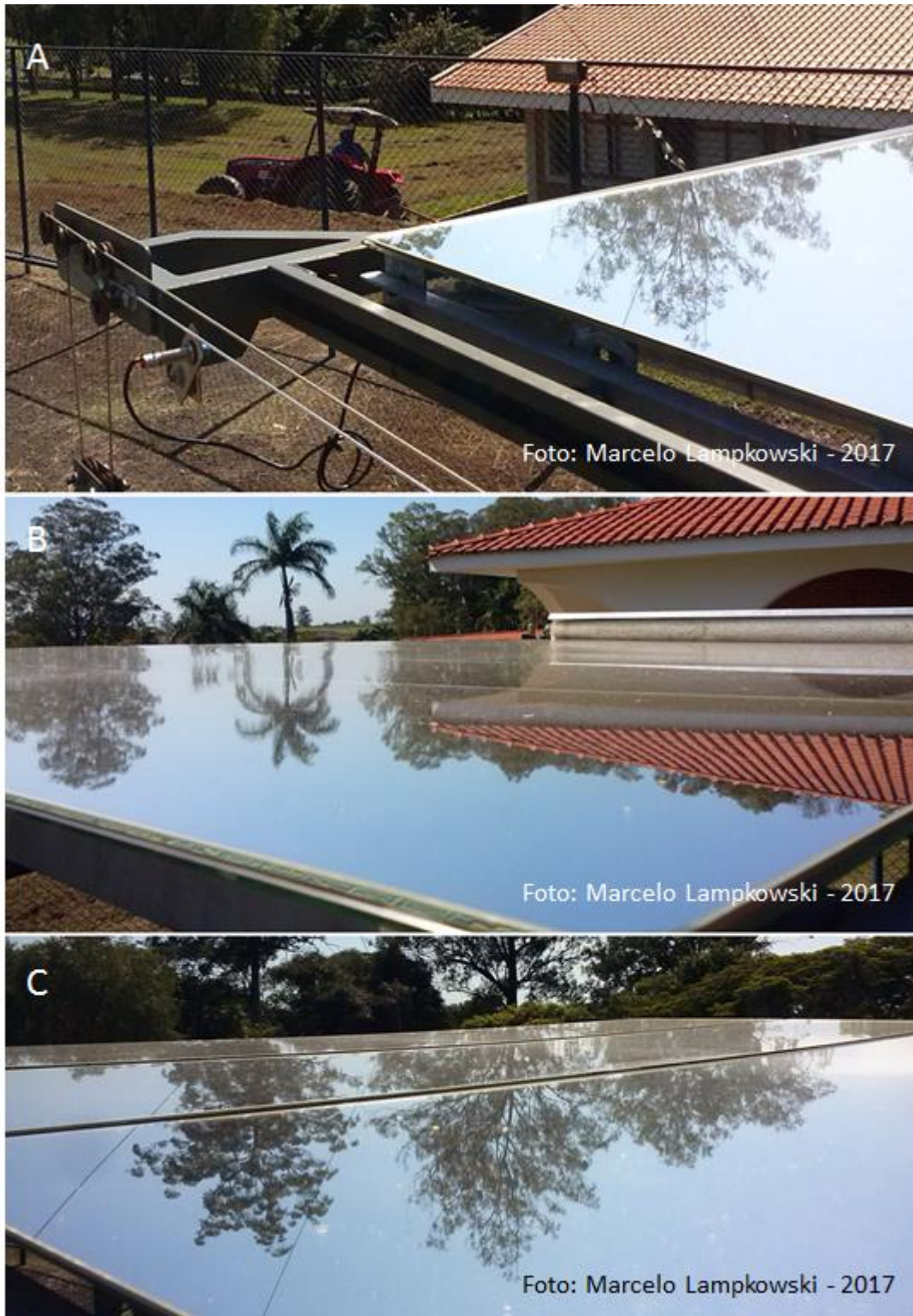
Figura 67 - Situação da sujidade nos espelhos registrada no dia 16/03/2017, durante e após o corte da grama
