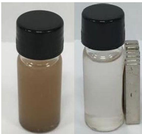
Figura 30 – Nanopartícula na ausência e presença de campo magnético.
