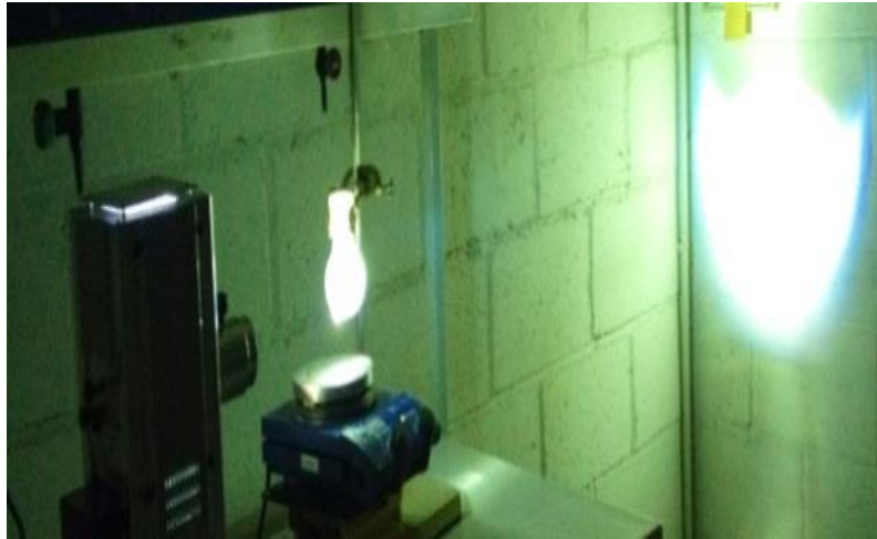
Figura 26 - Lâmpada UV utilizada na grafitação do NaSS.
