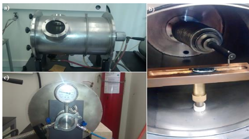
Figura 22 - Forno arco voltaico utilizado na fusão da liga Ti- 15Mo: (a) vista do forno; (b) interior do forno; (c) Forno de tratamento térmico.
