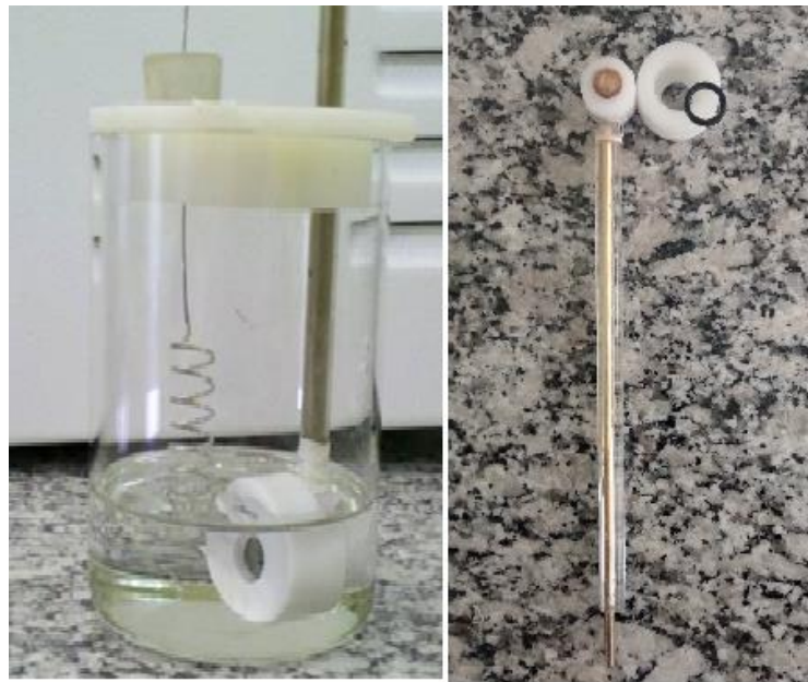
Figura 24 - Amostra na célula de oxidação anódica e porta-amostra utilizado no tratamento.
