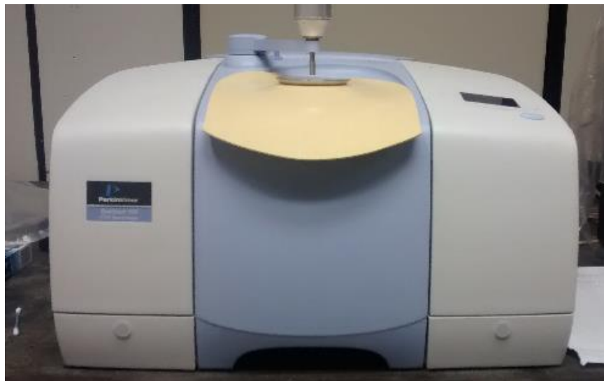
Figura 32 - Espectrômetro utilizado para avaliar os revestimentos poliméricos realizados.
