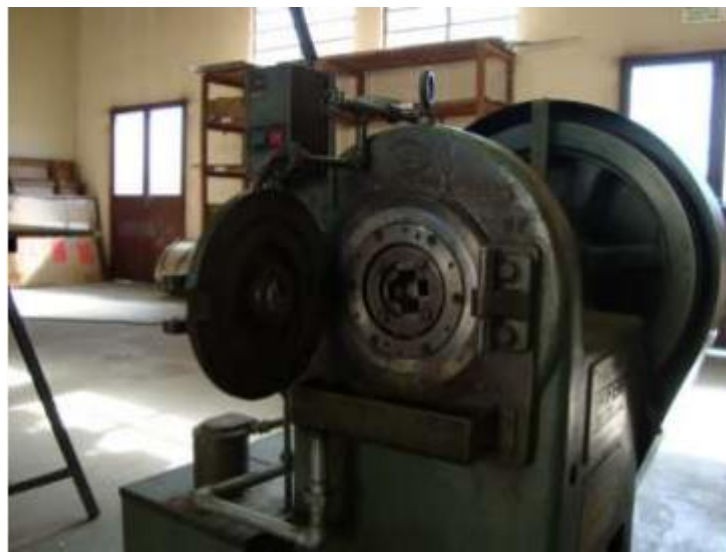
Figura 23 - Forja rotativa utilizada na conformação a frio dos tarugos.
