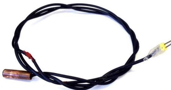
Figura 37 - Fotografia do encapsulamento de proteção do sensor de temperatura.
