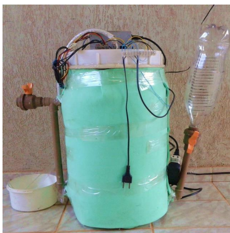
Figura 28 - Biodigestor revestido com manta térmica de EVA.
