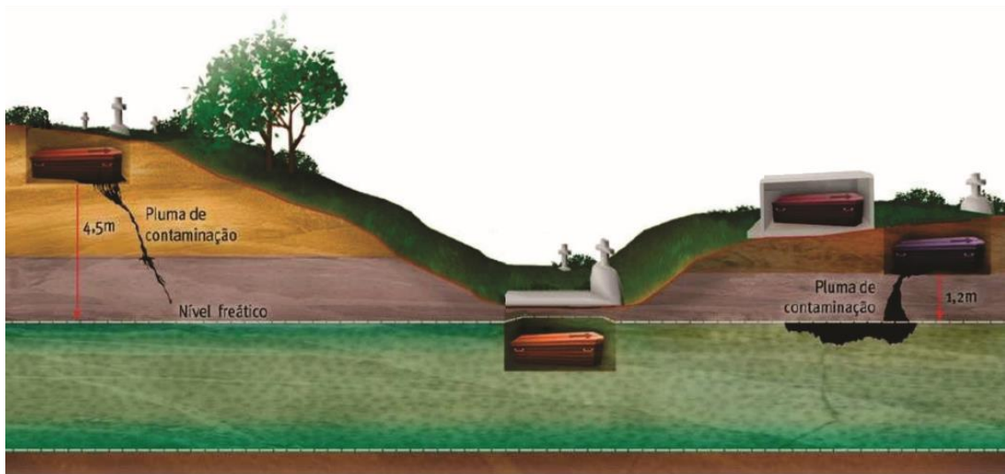
Figura 1: Esquemas de contaminação do solo e lençóis freáticos pelo necrochorume. Adaptado de Pacheco (2000).
