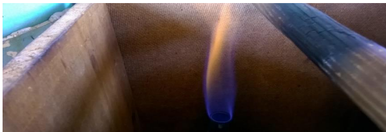
Figura 3 Demonstração da queima do biogás, feita pelo teste de queima.
