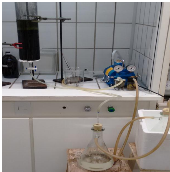
Figura 10 - Fotografia do sistema de fracionamento por EFS do extrato etanólico.
