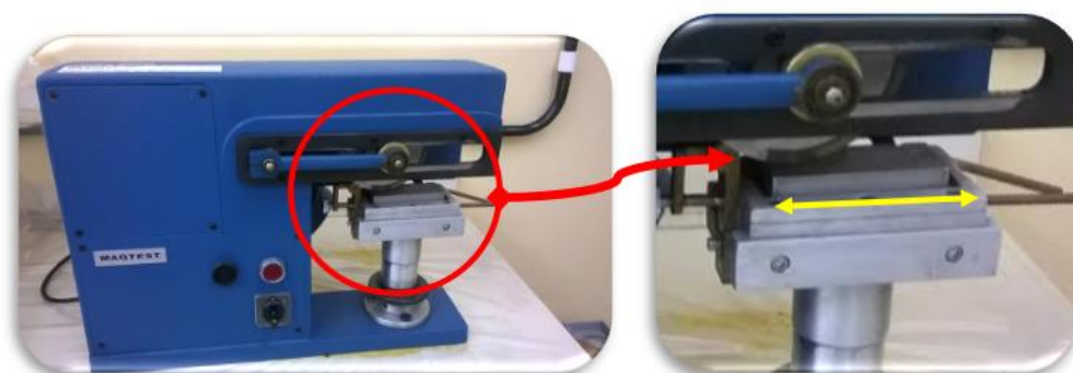
Figura 12. Permeômetro utilizado para realização da técnica de absorção de água. Fonte. O autor.
