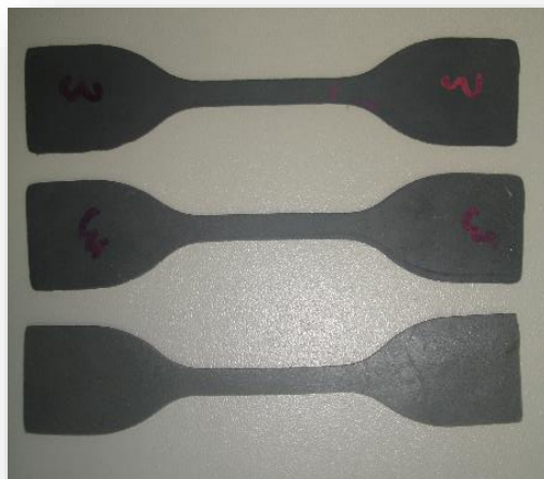
Figura 32: Corpos de prova para análise de tensão e deformação norma ASTM D 412. Fonte. O autor.
