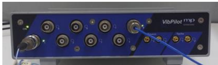
Figura 52 - Placa de aquisição de dados VibPilot m+p.
