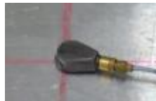
Figura 55 - Acelerômetro PCB Piezotronics®.
