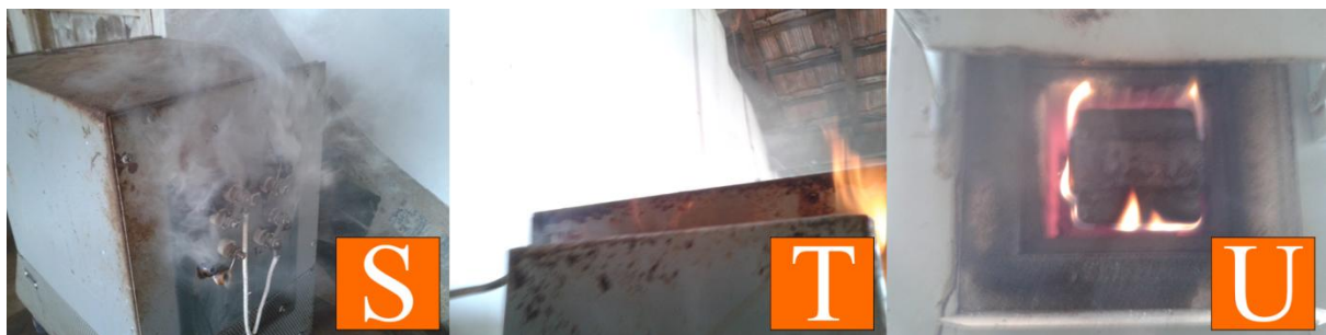
Figura 9 : Saída de gases inflamáveis, entrada de oxigênio e chamas.
