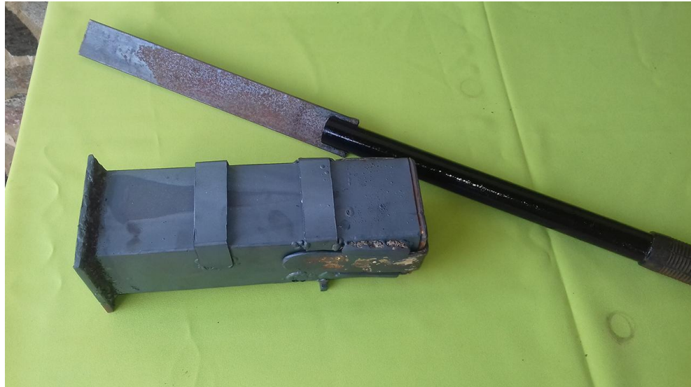
Figura 1: Mufla para a conversão de biomassas e cabo de manejo.
