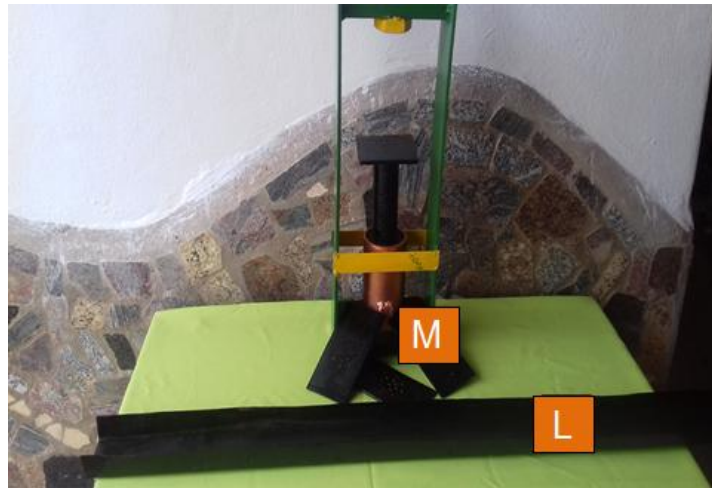
Figura 6 : Máquina, peneiras e calha.
