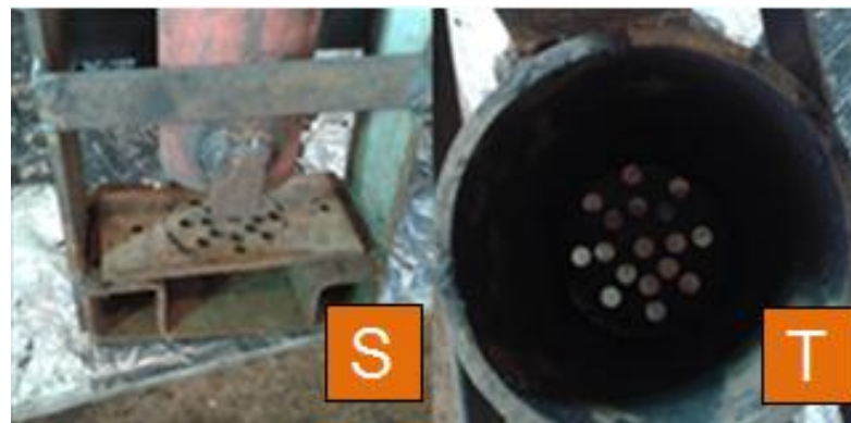
Figura 11: Sequência operacional de peletização de biomassas. S) Elevação do cilindro para a colocação da peneira com o diâmetro escolhido. T) Vista interna do cilindro, equipamento pronto para receber a biomassa a ser peletizada. Fonte: PROENÇA, U. C. M.
