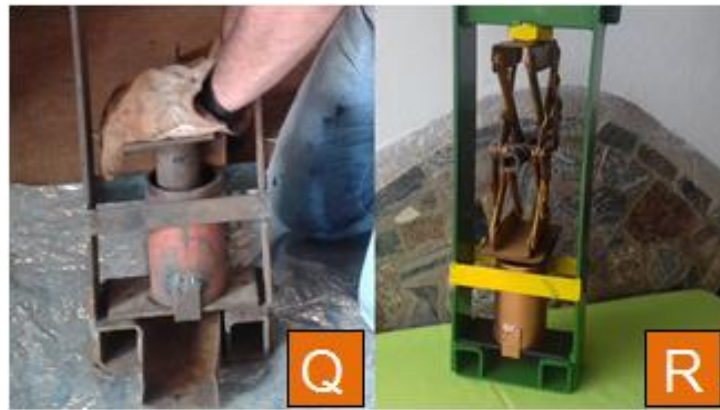
Figura 10: Utilização de força humana e mecânica. Q) Pistão sendo acionado pela ação da força humana. R) Pistão acionado por macaco mecânico. Fonte: PROENÇA, U. C. M.
