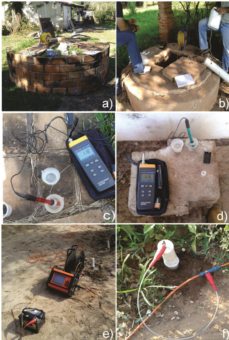
Figura 21 - Procedimentos adotados em campo: a) poço de captação de água; b) leitura da profundidade do poço; c) medidas de Eh; d) medida de pH; e) resistivimetro utilizado na aquisição; f) eletrodos
