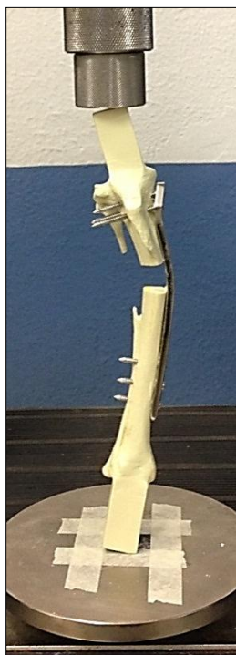
Figura 14 – Dobramento da placa TPLO modificada (Grupo 1) durante o ensaio de compressão axial. Notar que o ponto de maior deflexão do implante é na região da falha do corpo de prova.
