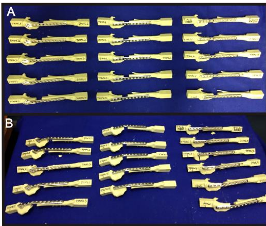
Figura 23 – Aspecto antes (A) e depois (B) dos corpos de prova dos três grupos após ensaio de flexão médio lateral. Observar a flexão da placa na região da falha do corpo de prova em todas as construções (B).
