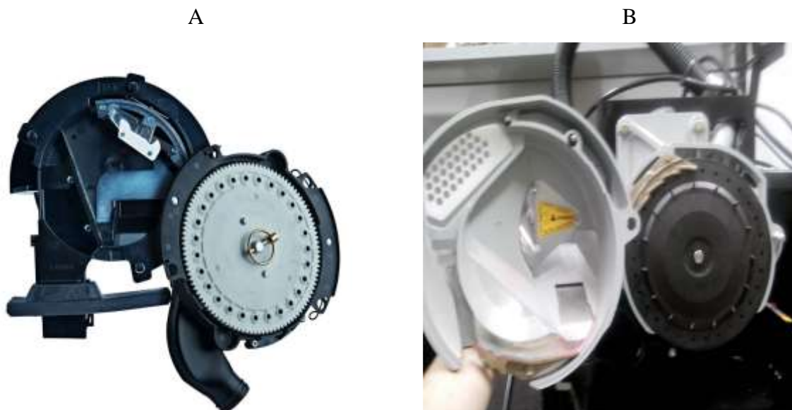
Figura 2: mecanismo dosador de sementes de poliacetal (A), mecanismo dosador de alumínio (B).
