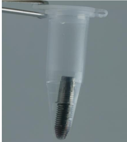
Figura 14: Implante desembutido com a interface pilar/implante submersa a água destilada.
