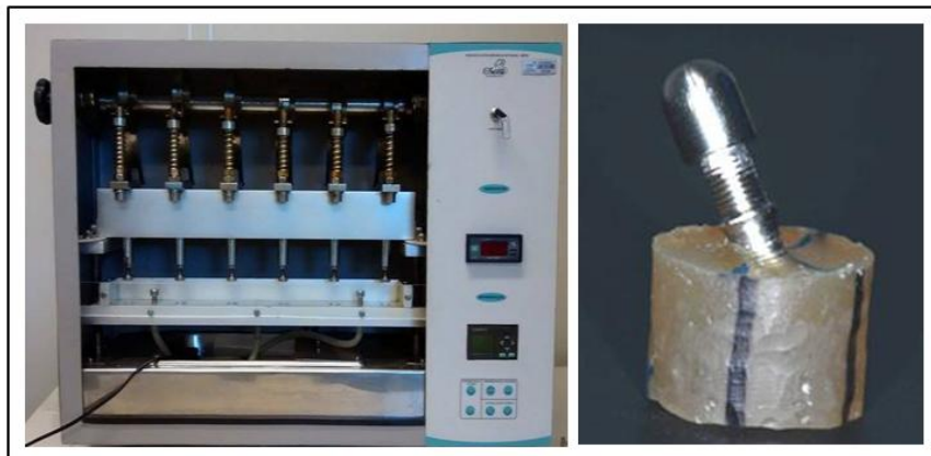
Figura 9: À esquerda, vista frontal do equipamento eletromecânico de ensaio de fadiga por mastigação. A direita, close de um espécime com o dispositivo de simulação da coroa protética.
