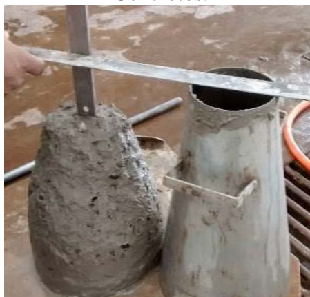
Figura 10.3 – Ensaio de Abatimento do Tronco de Cone ( Slump Test ) aplicado às misturas de Concretos.
