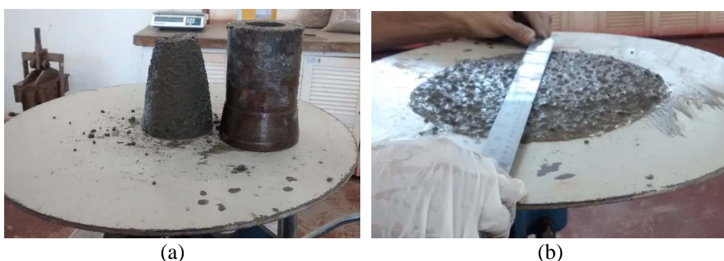
Figura 8.2 – Ensaio de Mini-Slump (a) e Mesa de Consistência “Flow Table” (b) aplicados às misturas de Microconcretos.
