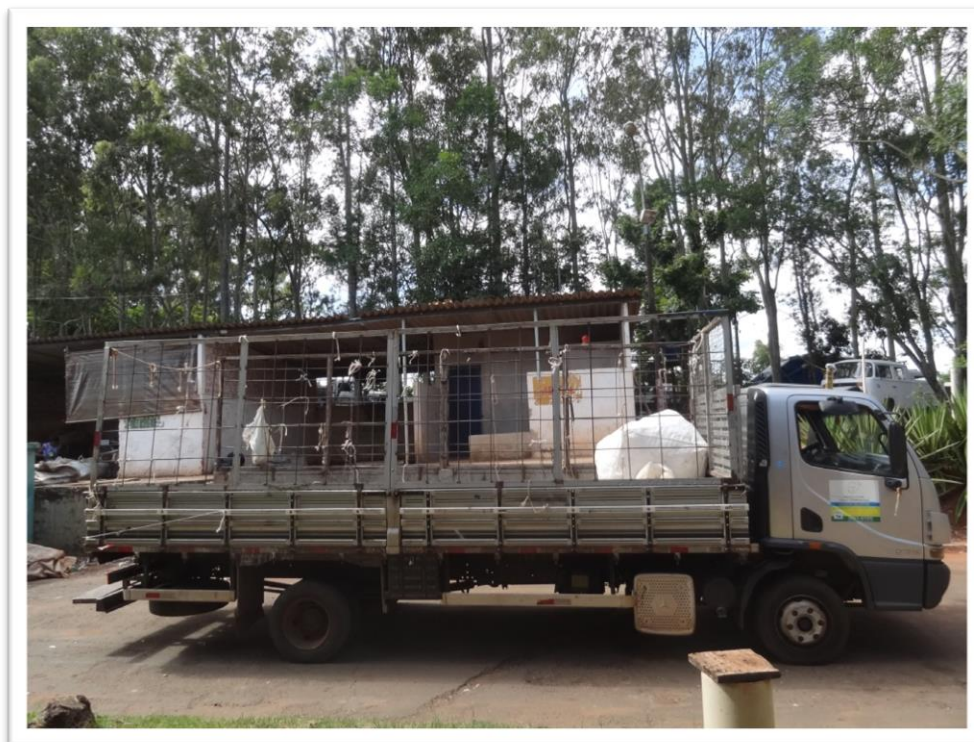
Fotografia 15 - Caminhão gaiola utilizado para realização da coleta seletiva da COOCASSIS
