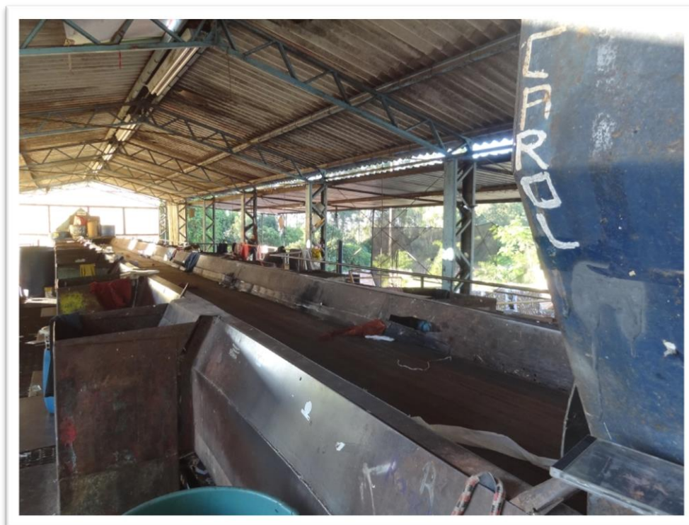
Fotografia 16 - Esteira para realização da triagem dos materiais recicláveis da COOCASSIS
