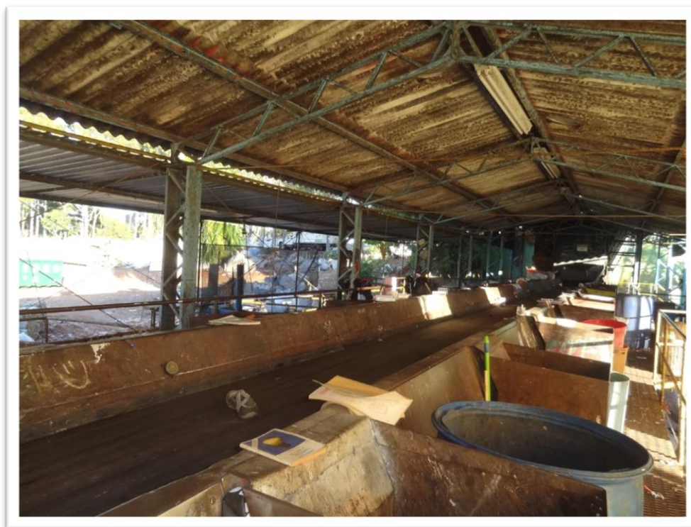
Fotografia 17 - Esteira para realização da triagem dos materiais recicláveis da COOCASSIS
