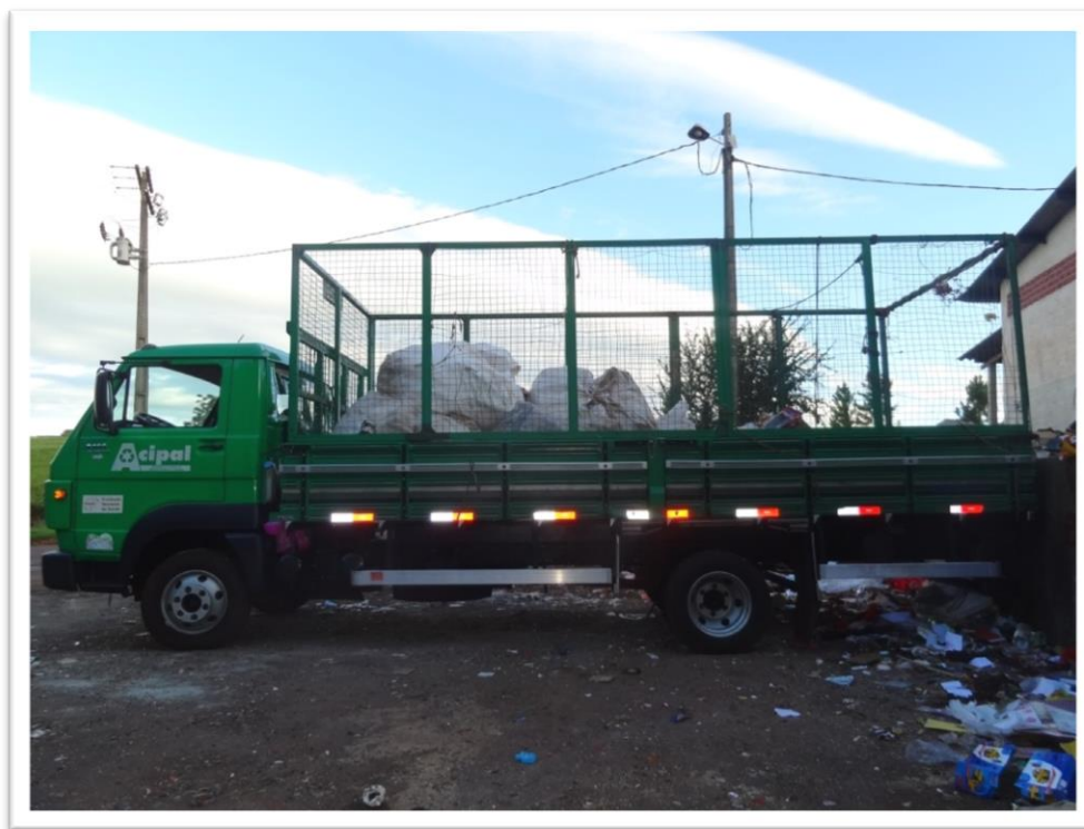
Fotografia 38 – Caminhão gaiola utilizado para realização da coleta seletiva da ACIPAL
