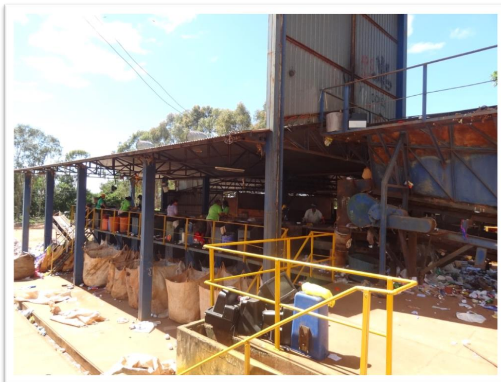
Fotografia 43 - Esteira de triagem dos materiais recicláveis da COOPACAM
