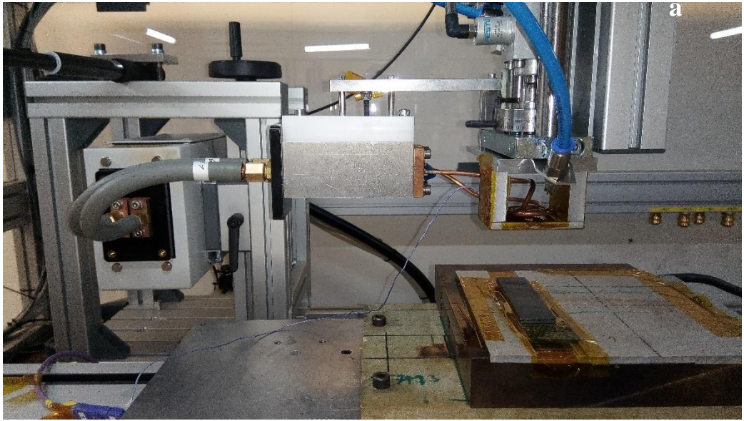
Figura 10 - Sistema de indução: (a) amostra preparada para a soldagem por indução e (b) soldadora utilizada.
