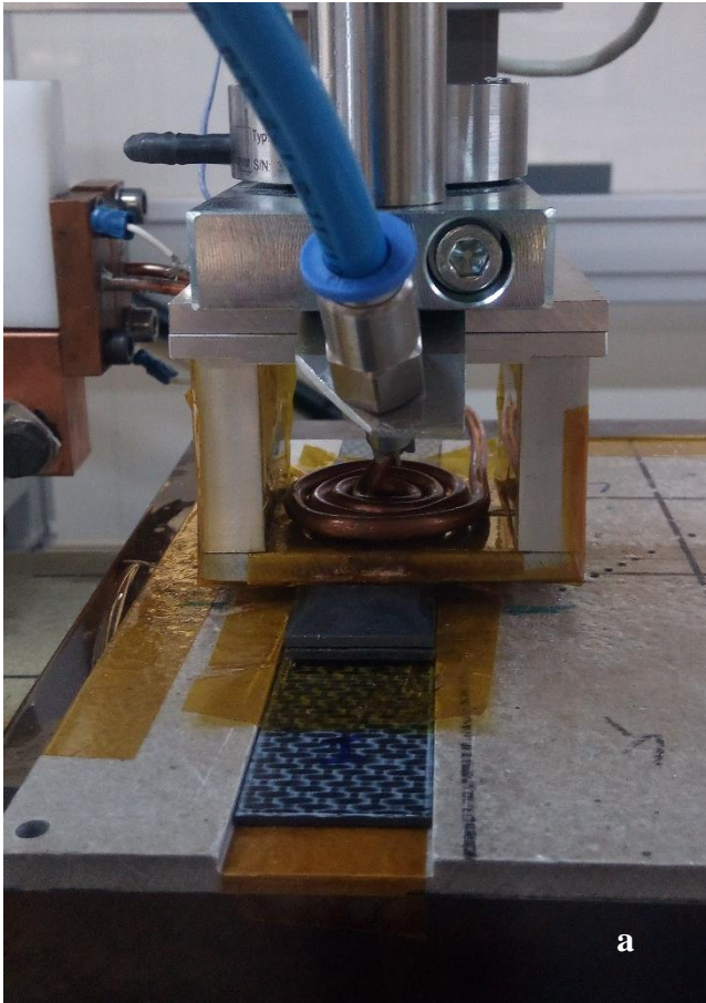
Figura 51 - Soldagem por indução: (a) Amostra sendo soldada; (b) Fita queimada após a soldagem.
