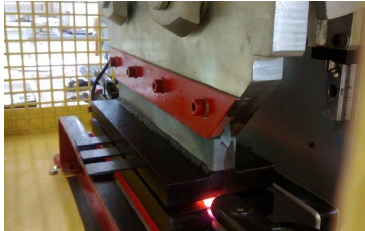
Figura 40 - Corpos de prova para os ensaios de Lap Shear sendo soldados (soldadora por resistência elétrica).
