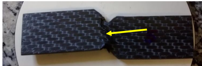
Figura 65 - Amostra fraturada de Iosipescu.
