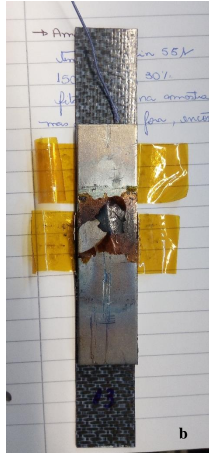
Figura 51 - Soldagem por indução: (a) Amostra sendo soldada; (b) Fita queimada após a soldagem.
