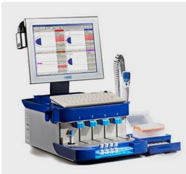
Figura 6 Rotem ® delta sistema de análise hemostática. Fonte: https://www.rottem-usa.com/products/rotem-delta/ , Acesso em 03 de abr de 2016
