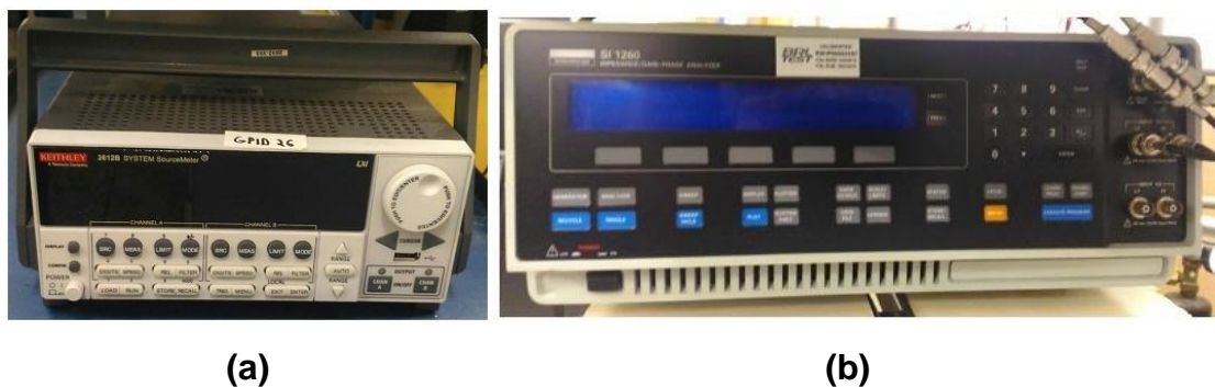
Figura 14: Equipamentos utilizados para a realização das caracterizações elétricas. (a) SourceMeter Keithley 2612B; (b) Solartron 1260 (Impedance/Gain-Phase Analyzer)
