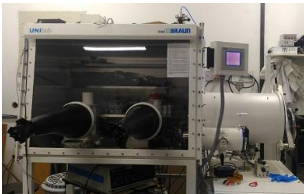
Figura 13: Equipamento utilizado para o controle da atmosfera durante as medidas elétricas-Glovebox Workstation MBUnilab 1200/780.
