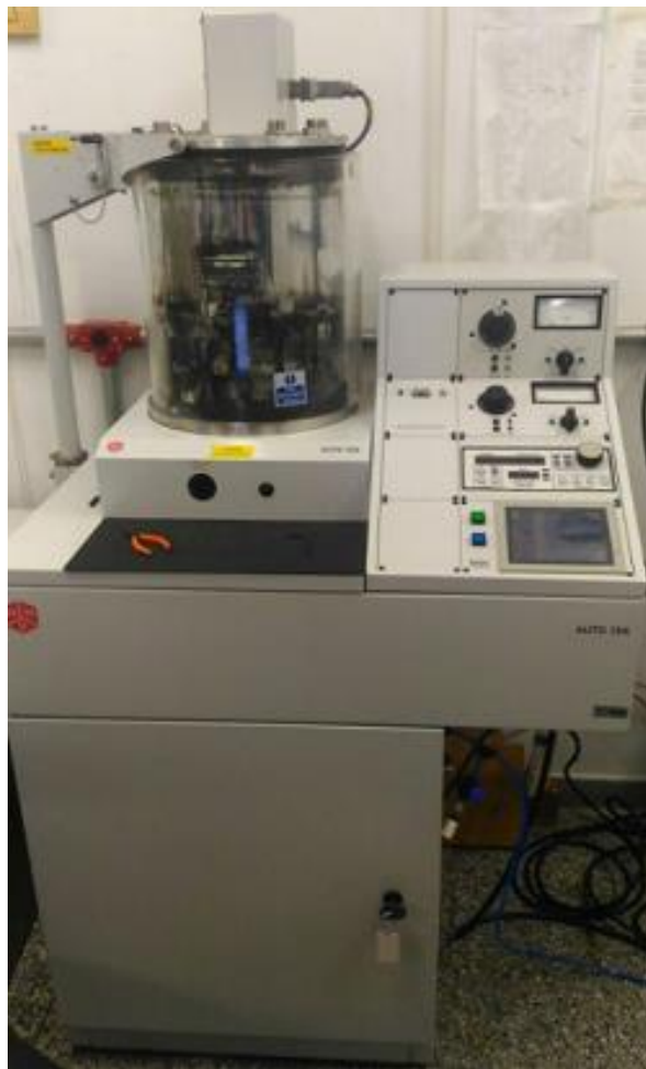
Figura 12: Equipamento utilizado para a evaporação dos contatos metálicos – HHV Ltd-Auto306 Lab Coater.
