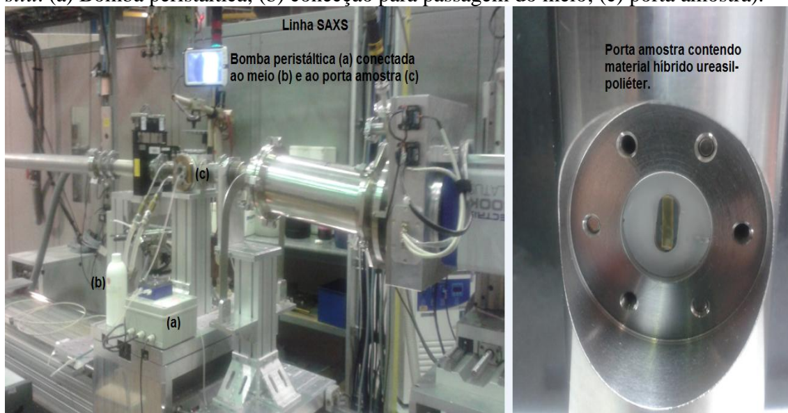
Figura 12. Linha de SAXS adaptada para avaliação de medidas de intumescimento in situ . (a) Bomba peristáltica; (b) conexão para passagem do meio; (c) porta amostra).
