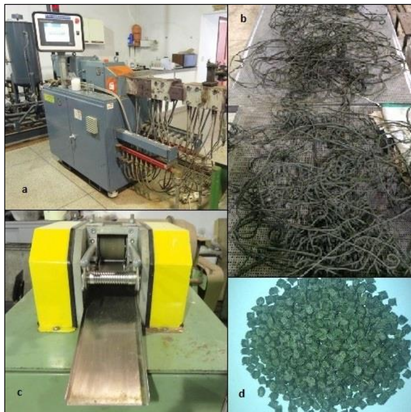
a) extrusora dupla rosca, marca Coperion, modelo ZSK 25, l/d 36 b) compósito sendo resfriado dentro do laboratório c) triturador peletizador, marca Sagec; d) pellets saídos do triturador
