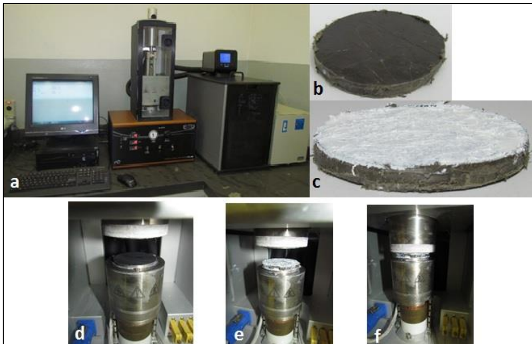
FIGURA 25 - EQUIPAMENTO DTC 300 E PROCESSO PARA AVALIAÇÃO DA CONDUTIVIDADE TÉRMICA
