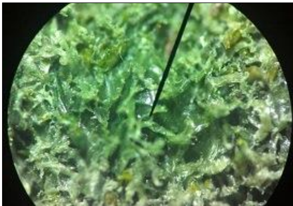
FIGURA 60 - MATRIZ SEM REFORÇO. TRATAMENTO 8: BOPP 100. PROCESSO: MISTURADOR TERMOCINÉTICO DRAIS + INJETORA
