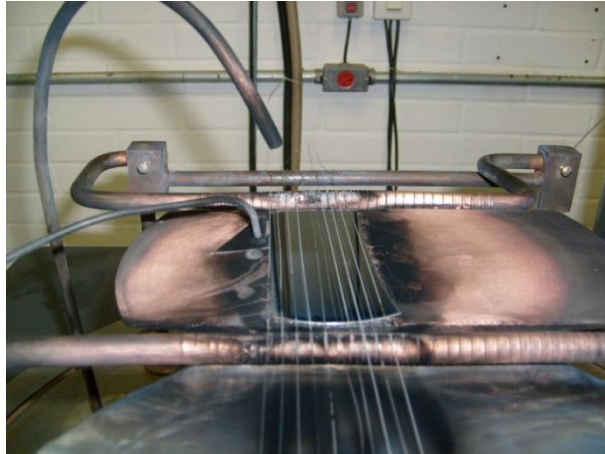
Figura 17 - Substrato de silício colocado no interior do reator, sob os filamentos.
