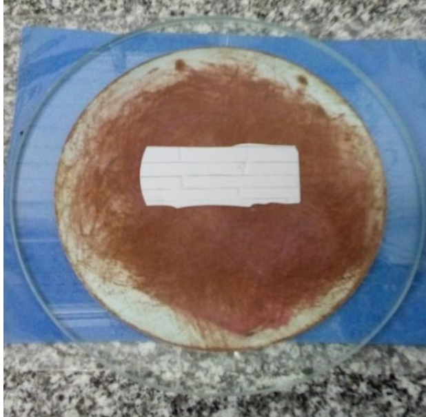
Figura 15 - Superfície de lixamento para preparação do substrato.
