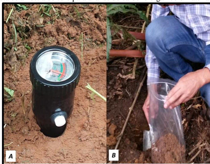
Figura 5 - [A]: aparelho medidor de umidade e pH do solo e [B]: coleta de amostra de solo para análise do carbono orgânico e matéria orgânica.
