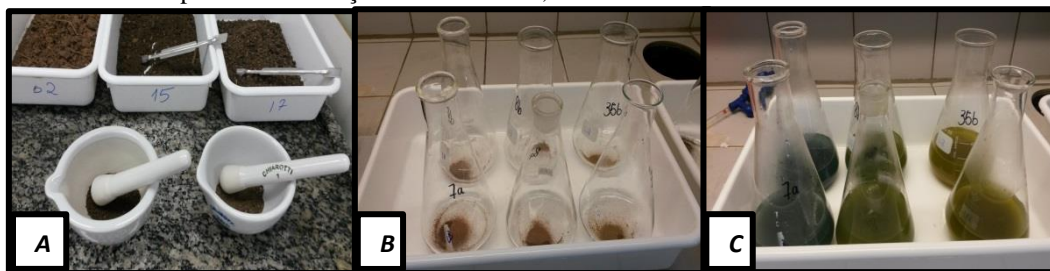
Figura 6 - [A]: preparação da amostras; [B]: amostras em erlenmayer peneiradas e pesadas e pesadas e [C]: amostras em repouso com soluções de dicromato, ácido sulfúrico e ácido ortofosfórico.
