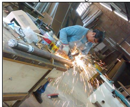
Figura 9: Abertura de tubos de ferro com amostras de depósitos tecnogênicos
