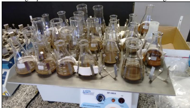
Figura 23: Agitação das amostras com hidróxido de sódio e água deionizada
