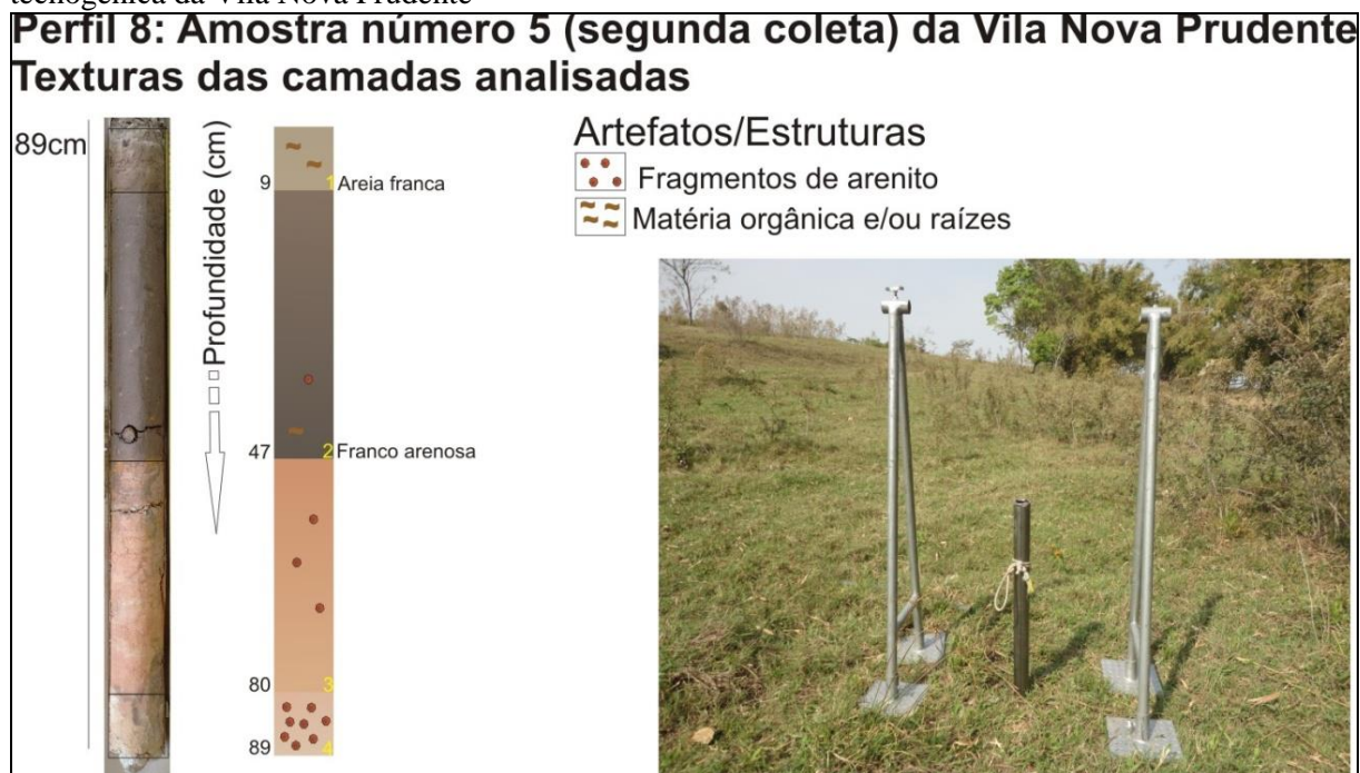
Figura 80: Perfil da quinta amostra da segunda coleta de depósito tecnogênico realizada na planície tecnogênica da Vila Nova Prudente
