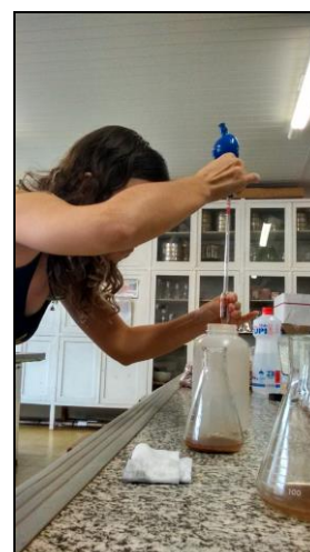
Figura 22: Uso do pipetador e da pipeta para mensurar a quantidade de hidróxido de sódio
