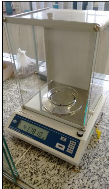
Figura 25: Pesagem de Placa de Pétri com o auxílio da balança analítica
