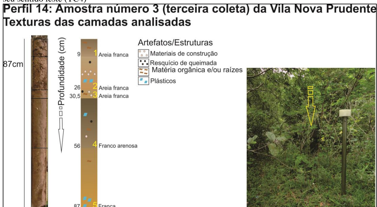
Figura 91: Perfil da terceira amostra de depósito tecnogênico coletada nas proximidades da ravina, no seu sentido leste (TC4)
