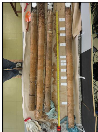
Figura 17: Identificação das camadas de deposição e medida de suas profundidades
