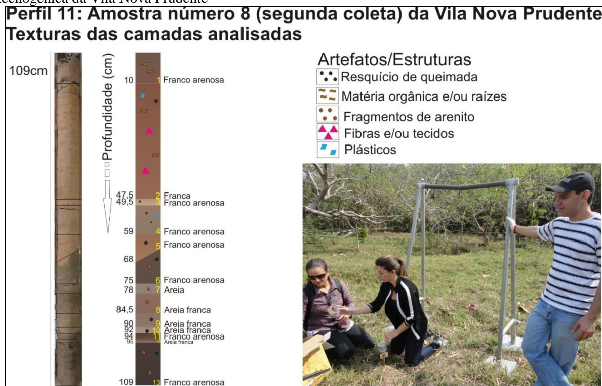
Figura 83: Perfil da oitava amostra da segunda coleta de depósito tecnogênico realizada na planície tecnogênica da Vila Nova Prudente
