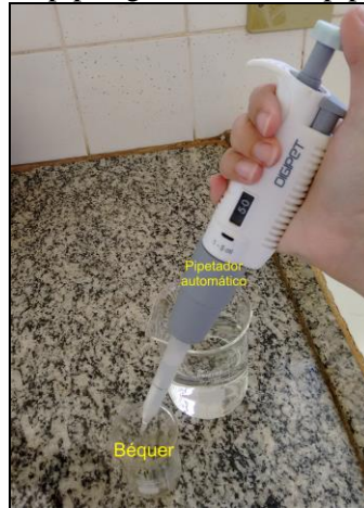
Figura 26: Etapa de pipetagem utilizando pipetador automático
