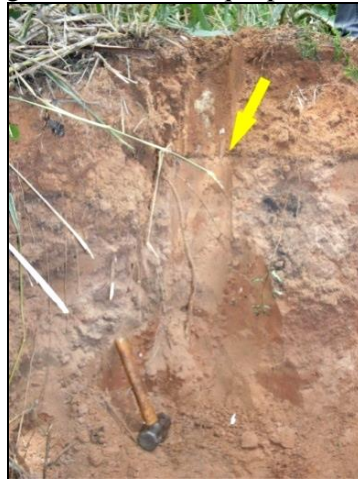
Figura 64: Perfil do depósito tecnogênico, com destaque para a camada com resquícios de queimada
