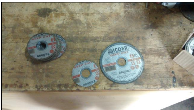
Figura 8: Discos de corte utilizados para abertura dos tubos de ferro
