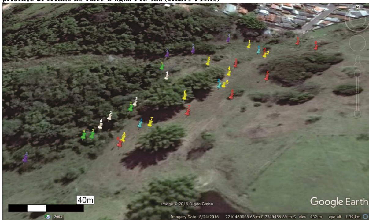
Figura 15: Localização dos pontos de realização de tradagens (vermelho), sondagens à percussão (azul claro, amarelo e verde), coleta de amostra no talude da ravina (verde), aferição da profundidade da presença de arenito no curso d'água e ravina (branco e roxo)
