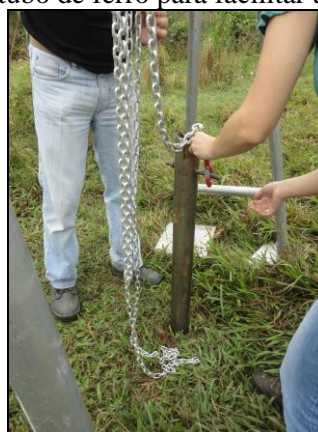
Figura 7: Adaptação realizada próximo a abertura superior do tubo de ferro para facilitar a coleta
