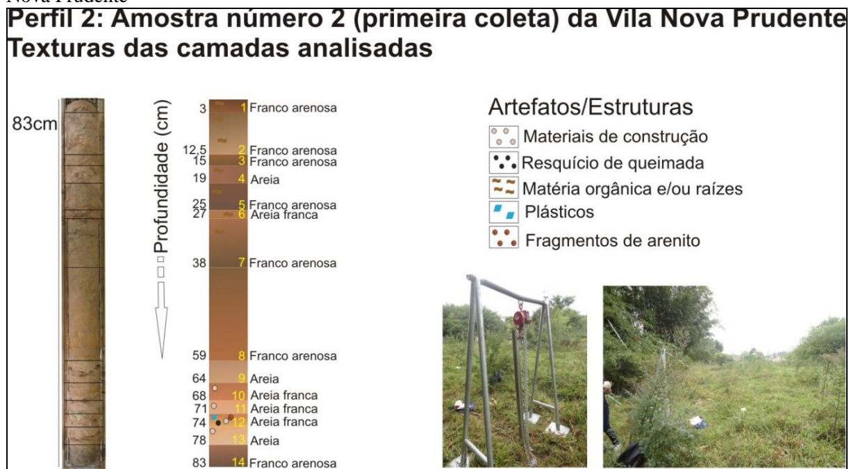
Figura 74: Perfil da segunda amostra de depósito tecnogênico coletada na planície tecnogênica da Vila Nova Prudente
