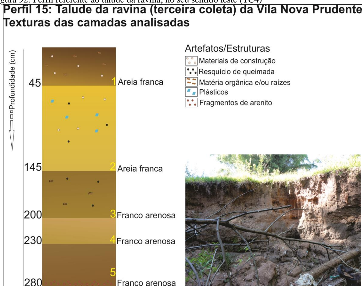
Figura 92: Perfil referente ao talude da ravina, no seu sentido leste (TC4)
