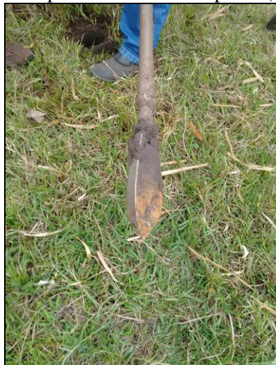
Figura 14: Trado Holandês utilizado para verificação da profundidade de camadas onde aparecem o arenito da Formação Adamantina intemperizado. Penúltimo ponto (de montante a jusante)
