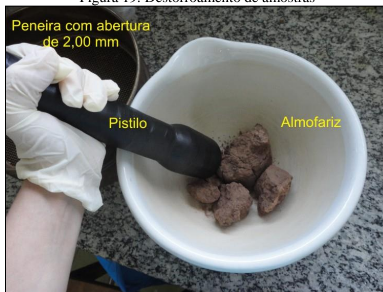
Figura 19: Destorroamento de amostras
