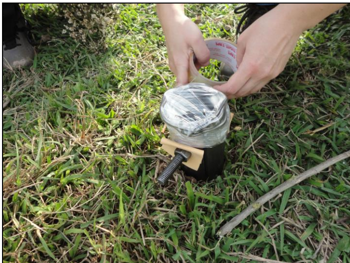
Figura 12: Vedação da extremidade superior do tubo após a penetração na superfície
