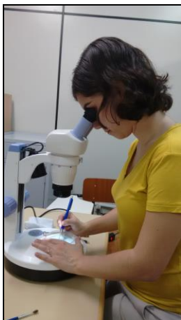
Figura 29: Procedimento de reconhecimento de materiais presentes na fração areia de algumas camadas dos depósitos tecnogênicos em estereomicroscópio com aumento de 4 vezes
