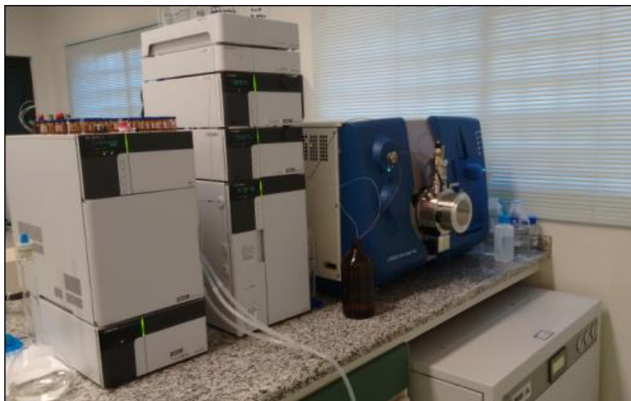
Figura 4 — Cromatógrafo Líquido (Proeminence UFLC) acoplado ao espectrômetro de massas TRIPLE QUAD 4500 (AB SCIEX). Botucatu - SP, 2017
