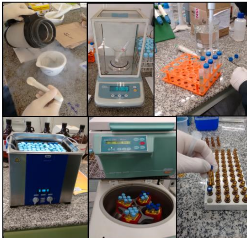
Figura 3 — Procedimentos para extração dos compostos a partir de amostras secas e maceradas. Botucatu – SP, 2017
