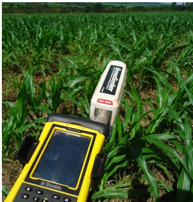
Figura 7. Coletor de dados/receptor GNSS e sensor GreenSeeker® utilizados para geração do NDVI.
