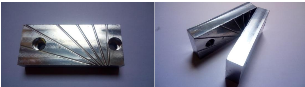
Figura 35 - Gabarito para fabricação do bisel.
