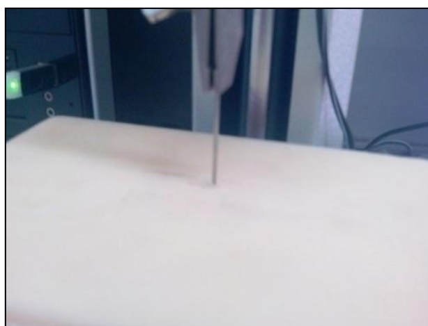
Figura 46 - Posicionamento da agulha para início do teste
