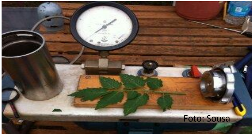
Figura 5 - Procedimento feito para potencial de água nas folhas com a bomba de pressão scholander
