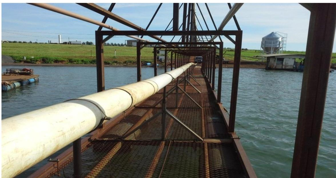
**Figura 4.** Despesca efetuada por sistema gravitacional para a retirada dos peixes.
