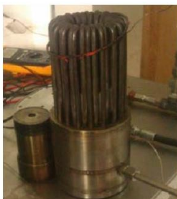
Figura 28 – Aquecedores do tipo tubular e anular respectivamente.
