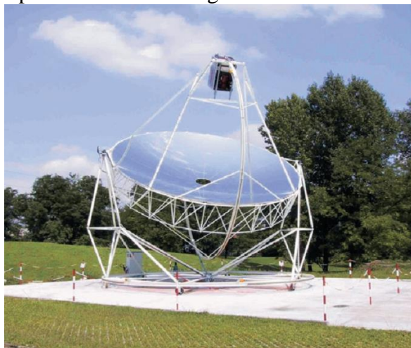
Figura 20 - Protótipo com motor Stirling e concentrador solar no norte da Itália.
