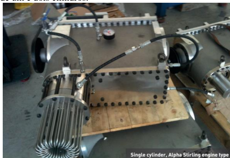
Figura 15 – Motores Stirling Genoa 01 e Genoa 03 que apresentam configuração respectivamente de um e dois cilindros.
