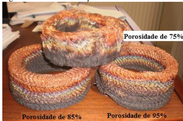
Figura 32 – Matrizes de aço inoxidável com diferentes porosidades.
