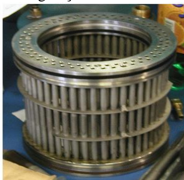
Figura 29 – Sistema de refrigeração do motor Stirling modelo solo V-161
