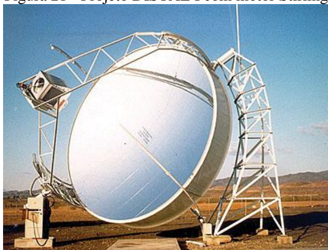
Figura 21 - Projeto DISTAL I com motor Stirling.
