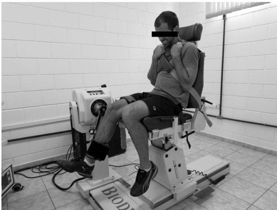
Figura 7. Posicionamento dos voluntários durante a execução das contrações isométricas máximas no dinamômetro isocinético.
